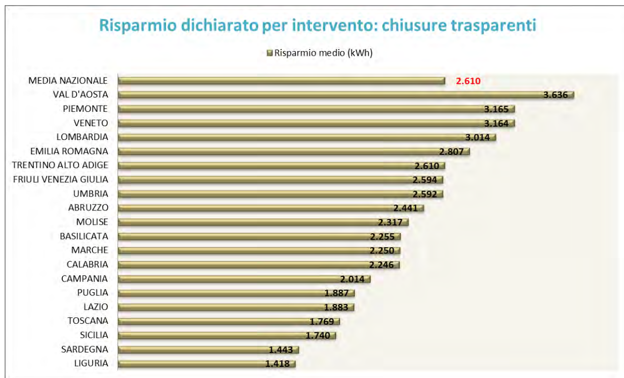
FIG.4.21 DISTRIBUZIONE REGIONALE DEL RISPARMIO MEDIO ANNUO CONSEGUITO CON LA SOSTITUZIONE INFISSI. VALORI ESPRESSI IN kWh/ANNO
