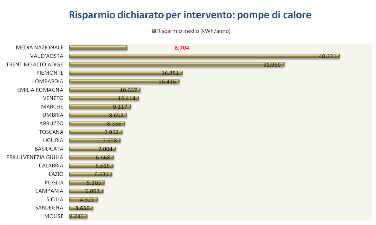
FIG.6.14 SOSTITUZIONE DI IMPIANTI TERMICI CON POMPE DI CALORE. RISPARMIO REALIZZATO CON L'INTERVENTO MEDIO NEL 2010. VALORI ESPRESSI IN KWh/ANNO
