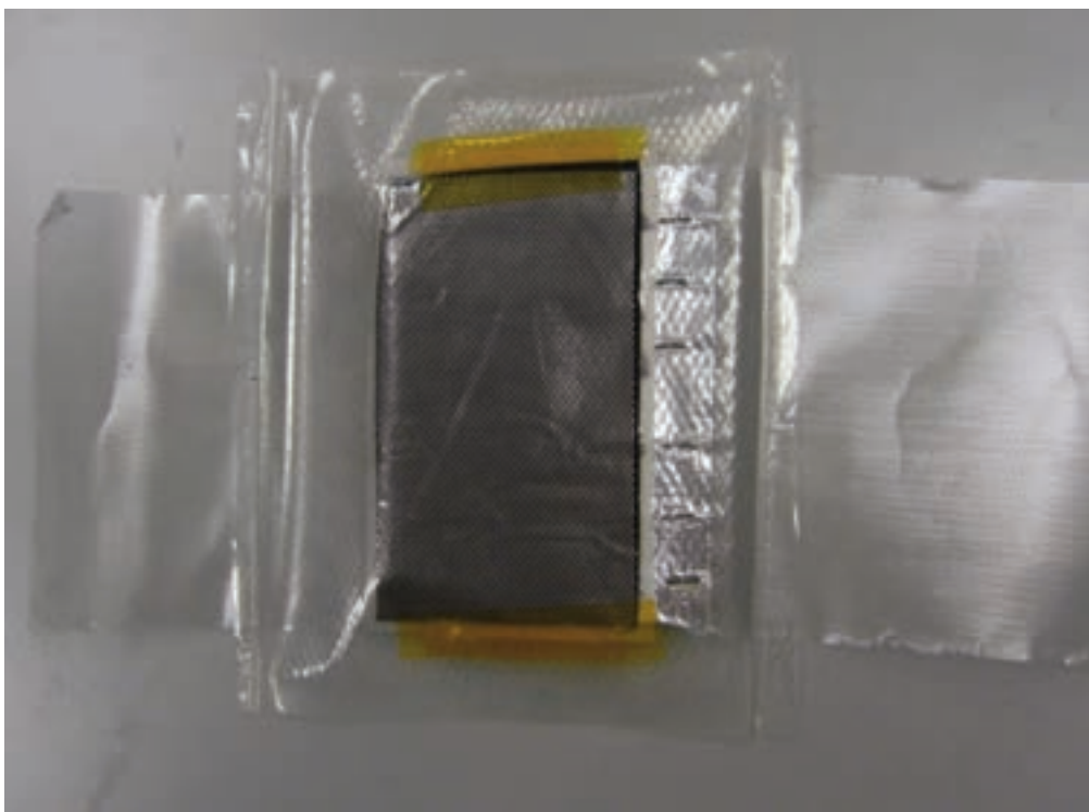
Celle ENEA litio-ione da circa 75 Ah pronta per le prove
