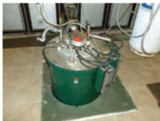
Criostato equipaggiato con magnete superconduttore da 14 T
