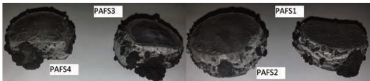
Campioni schiumati di precursori compositi con pelli di alluminio di spessore 1,5 +/-0,2 mm
