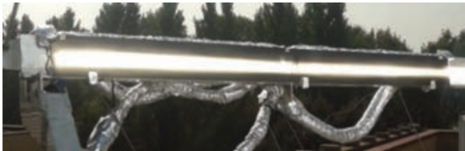
Prototipo di ricevitore termico a minicanali, installato sul concentratore, durante una prova
