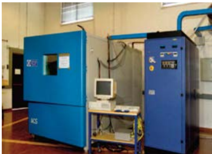
Attrezzatura per le prove del sistema di accumulo a batterie
