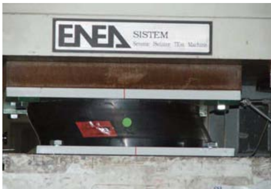
Isolatore in prova
