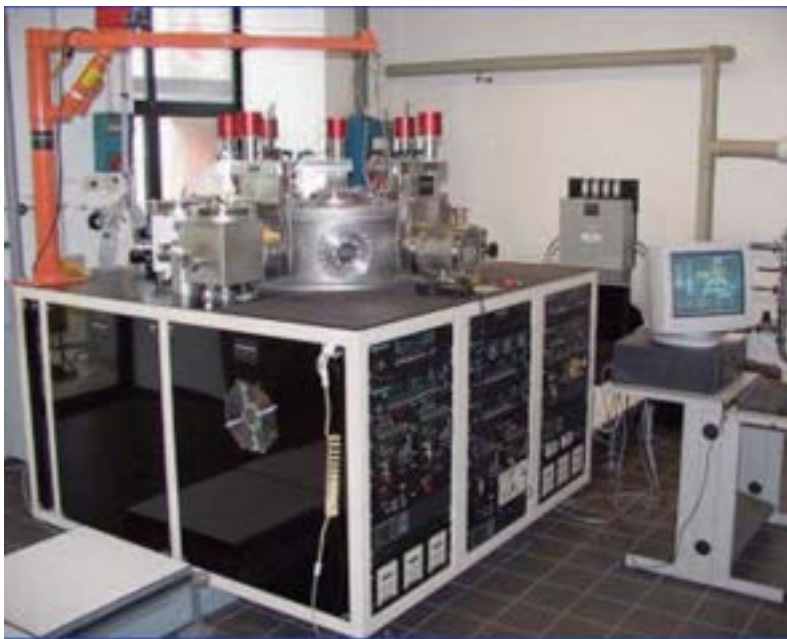
Impianto per la deposizione di film sottili di silicio con tecnica VHF-PECVD
