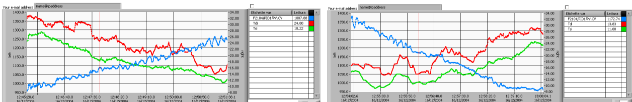
Figura 18. Variazione dei tempi di salita e discesa in funzione di aumento o diminuzione di portata di ossigeno
