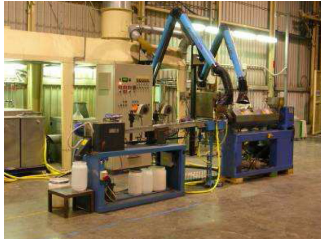
Figura 98. Impianto di estrusione per compound collegato al nuovo sistema di raffreddamento
