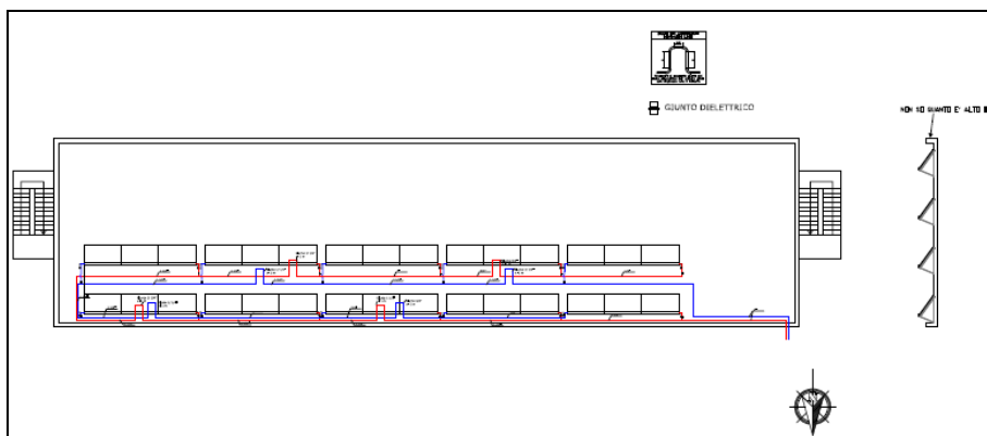
Figura 143. Schema disposizione collettori sul tetto
