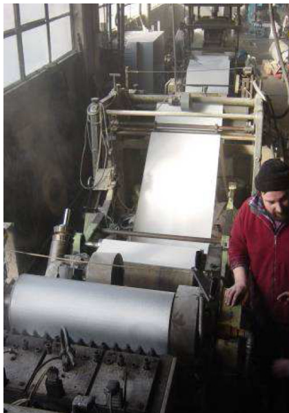
Figura 99. Estrusione delle lastre a base di plasto-ceramico (su base PE)
