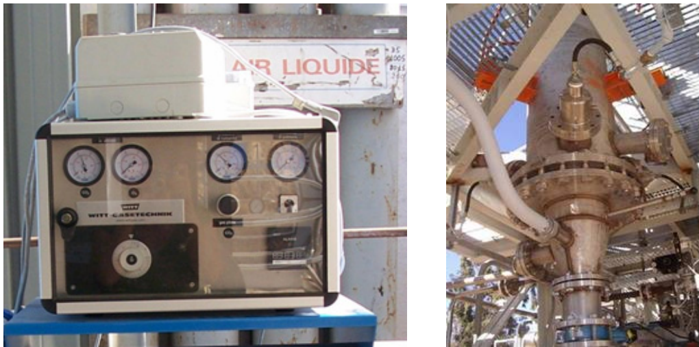
Figura 38. Dettaglio del miscelatore di O 2 e CO 2 e del gassificatore presso Sotacarbo
