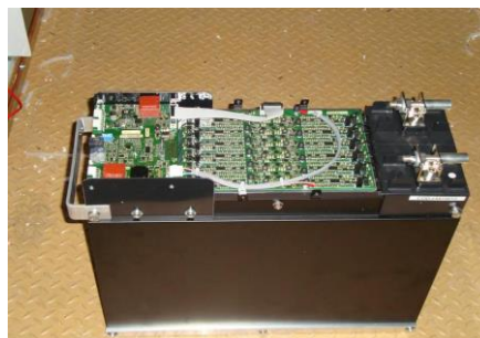
Figura 60. Pacco di accumulatori al litio polimerico
