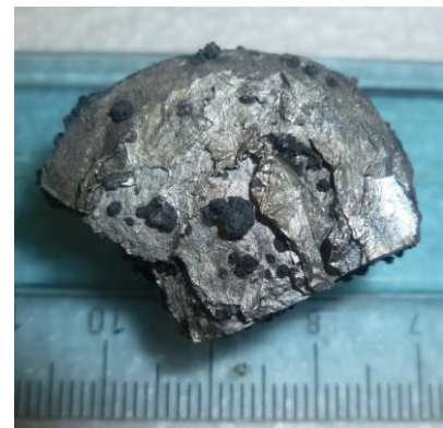
Figura 546. Campione (ID 13) schiumato con composti scuri in superficie
