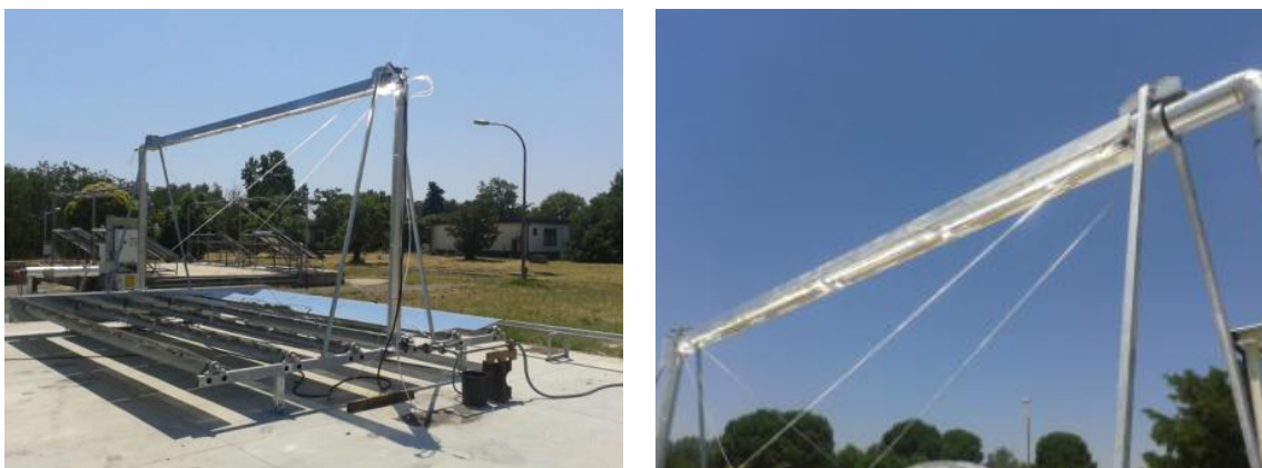
Figura 458. Collettore a specchi lineari di Fresnel in fase di sperimentazione
