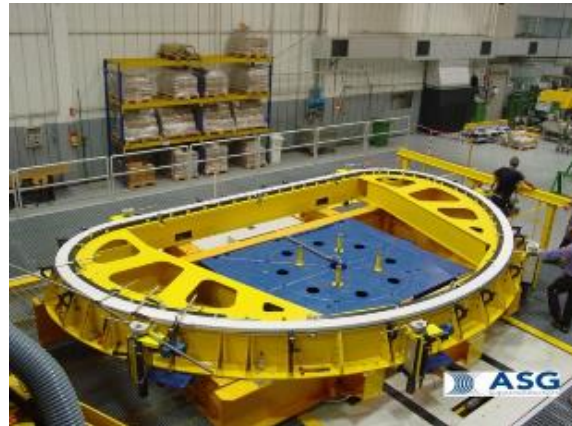
Figura 336. Doppio Pancake sulla tavola roto-traslante della linea di avvolgimento
