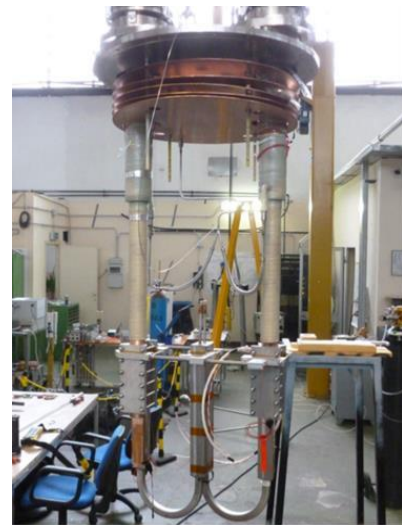
Figura 340. Giunto elettrico prima dell'immersione nel bagno di elio per la misura elettrica
