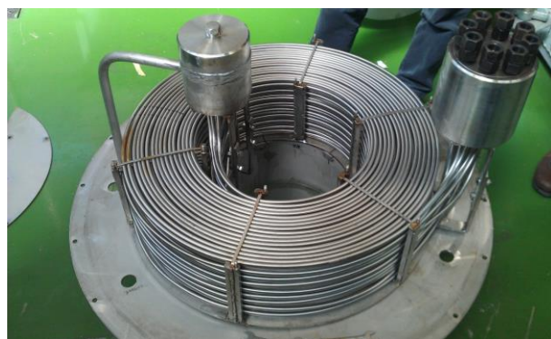
Figura 330. Vista del Generatore di Vapore a spirale piana per applicazione in sistemi a piombo
