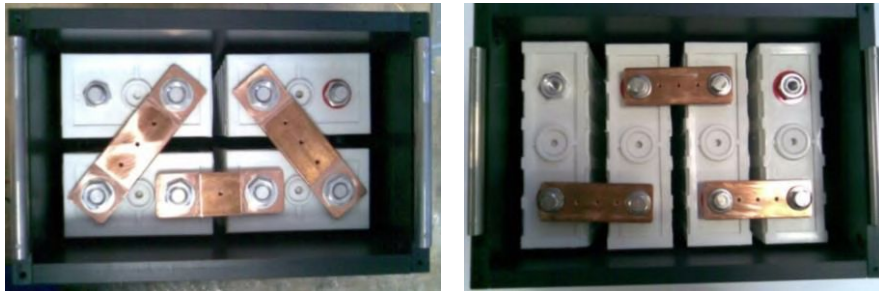
Figura 46. Vista interna dei nuovi moduli batterie: 30 Ah e 60 Ah (sinistra), 100 Ah (destra)
