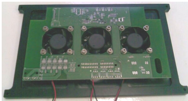
Figura 47. Nuova posizione della scheda elettronica BMS
