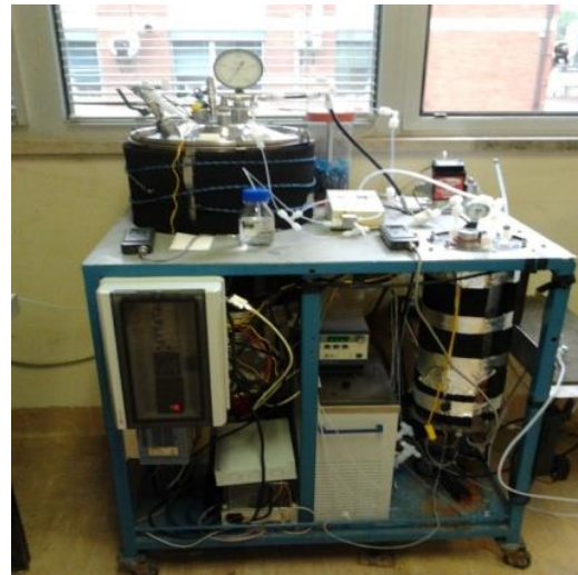
Figura 93. Impianto pilota di DA a doppio stadio
