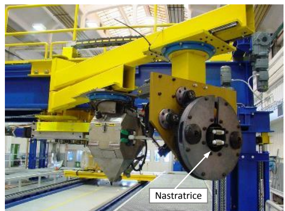
Figura 335. Nastratrice su braccio rotante
