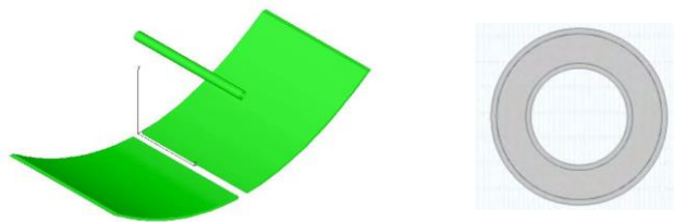
Figura 446. Immagine 3D del concentratore parabolico lineare e dettaglio del ricevitore in sezione
