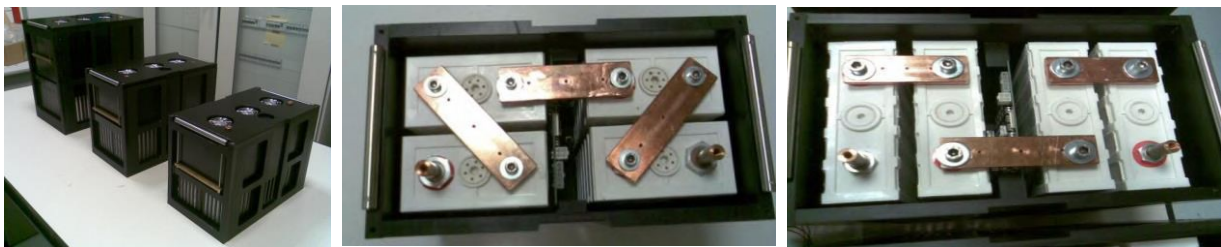
Figura 38. Vista interna ed esterna dei moduli al litio assemblati
