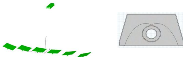
Figura 447. Immagine 3D del concentratore a specchi lineari di Fresnel e dettaglio del ricevitore in sezione
