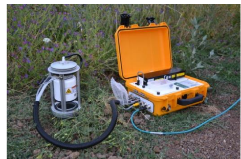
Figura 314. Dispositivo di misura del flusso di CO 2 a "camera di accumulo"
