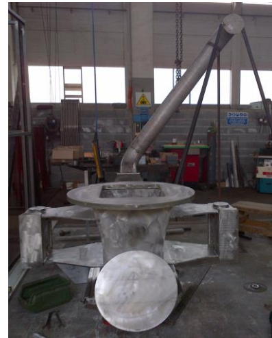
Figura 347. Target assembly durante la realizzazione
