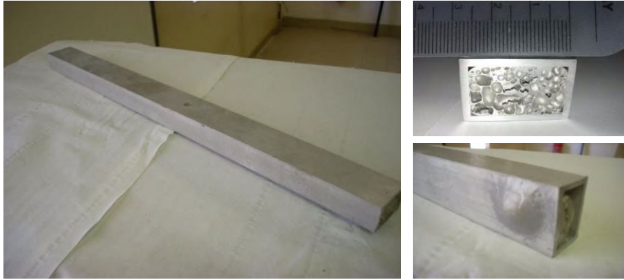
Figura 549. Profilato estruso di lunghezza 400 mm con evidenza della zona di collasso per eccessiva vicinanza alla parete posteriore del forno
