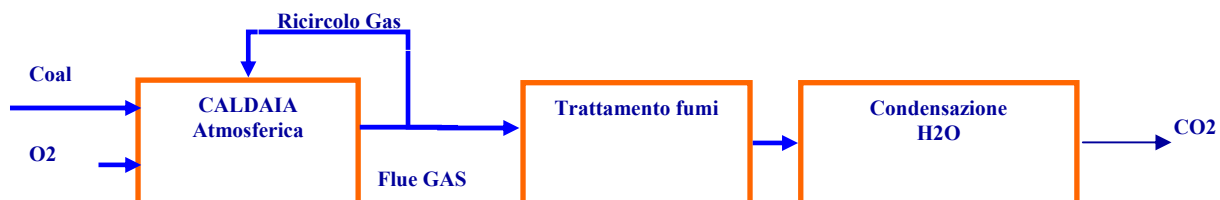
Figura 5.72 – Schema di impianto oxyfuel SC con separazione della CO 2 per condensazione
