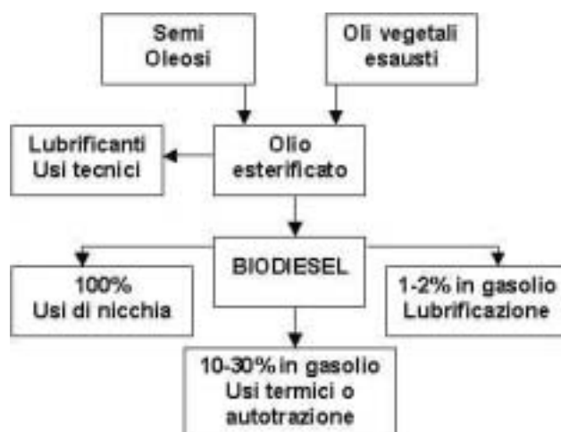
Figura 8.1.4 - Schema a blocchi della filiera biodiesel
