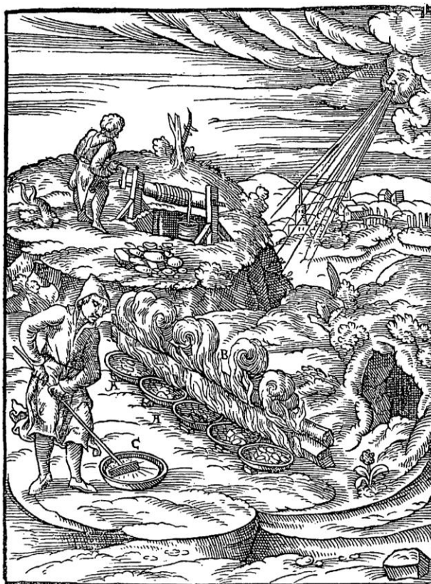
Fig. 1.10 - Raccolta dei minerali di bismuto e loro arrostimento, dalla Beschreibung aller fürnemisten mineralischen Ertzt vund Berckwercks arten di Lazarus Ercker. ERCKER 1574, p. 126v.
