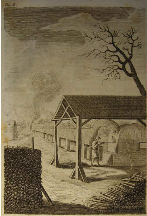
Fig. 4.14 - Fornace per l'arrostimento dei minerali di cobalto, con il lungo condotto orizzontale del camino per il recupero dell'arsenico, Fig. B dell' Ars vitraria experimentalis di Johann Kunckel. KUNCKEL 1679.
