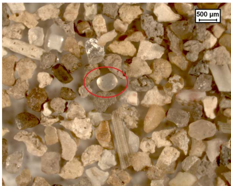
Fig. 7.6 - Osservazione al microscopio della frazione granulometrica pari a 500 \mu , separata dal campione S14 prelevato alla profondità di 11 m lungo la spiaggia sommersa. Esempio di granulo di quarzo (evidenziato con l'ellisse rossa) definito come arrotondato opaco
