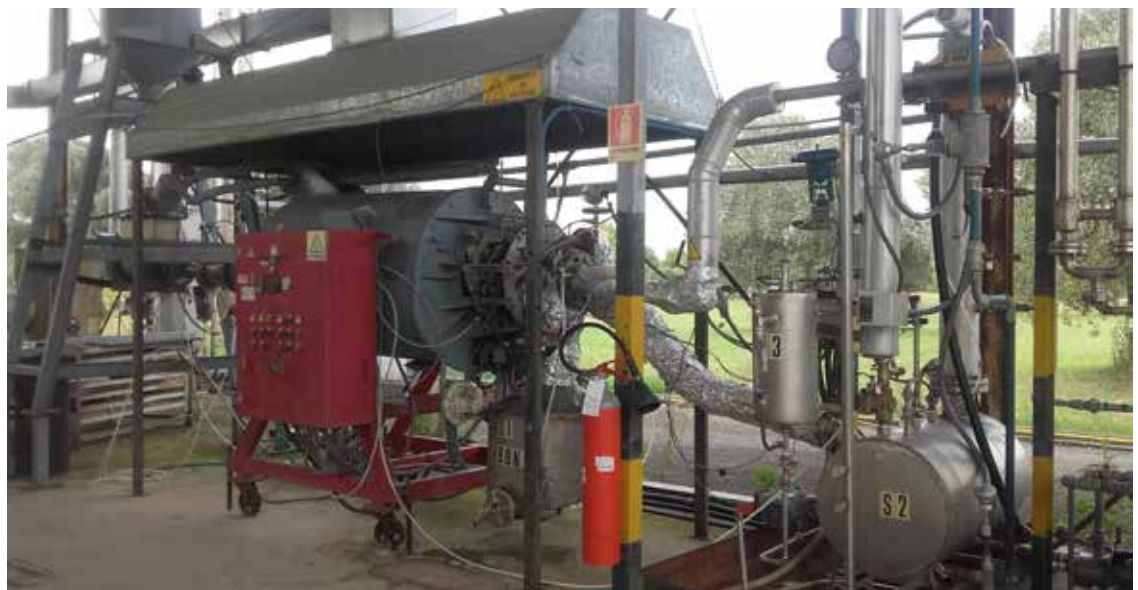
Figura 35: Impianto di pirolisi – gassificazione a tamburo rotante
