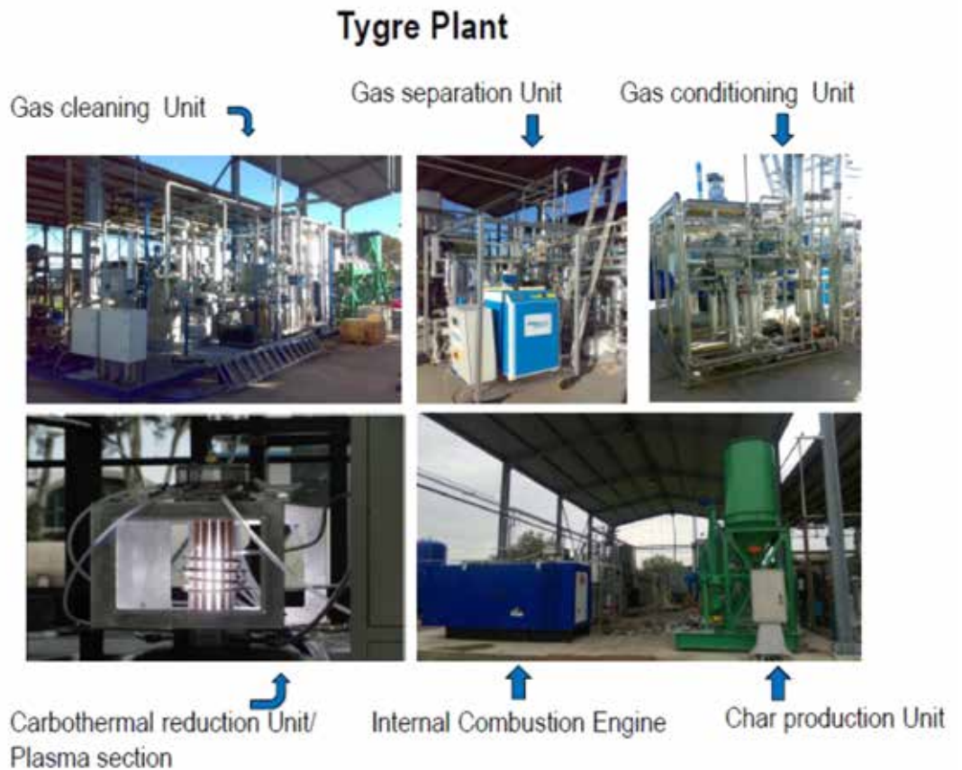
Figura 41: Schema di processo ed i prodotti ottenuti dal progetto Tygre
