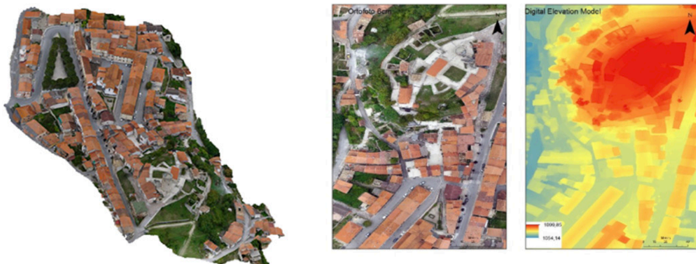
Figure 2, 3 e 4 – Modello 3D georeferenziato, Ortofoto e DEM di Aielli.
