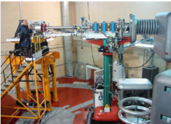
Esecuzione di prove di caratterizzazione RadHard di sensori FBG presso l'impianto Frascati Neutron Generator del Centro Ricerche ENEA di Frascati
