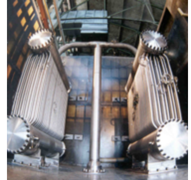
Prove termo-meccaniche sui sistemi di rimozione del calore di decadimento dei reattori LWR (reattore GE SBWR-PCC: 10 MW, 175 m 3 )
