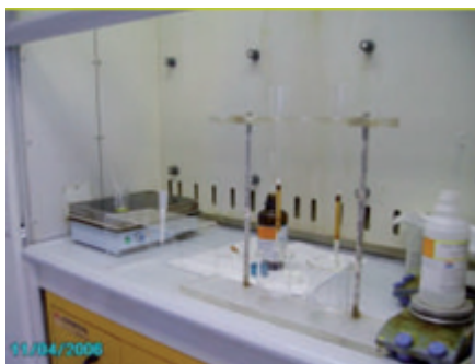
Trattamento radiochimico di campioni di bioassay per misure di isotopi del Plutonio e apparato di elettrodeposizione
