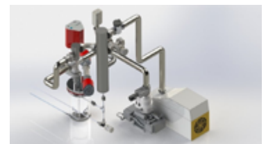
Impianto IELLLO: pompa a magneti permanenti in alto e, in basso, sezione di prova
