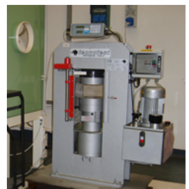
Pressa per prove di resistenza alla compressione dei provini cementizi
