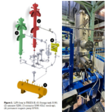
Impianto TRIEX II: sulla sinistra, 3D CAD; sulla destra, PAV installato sul circuito primario.
