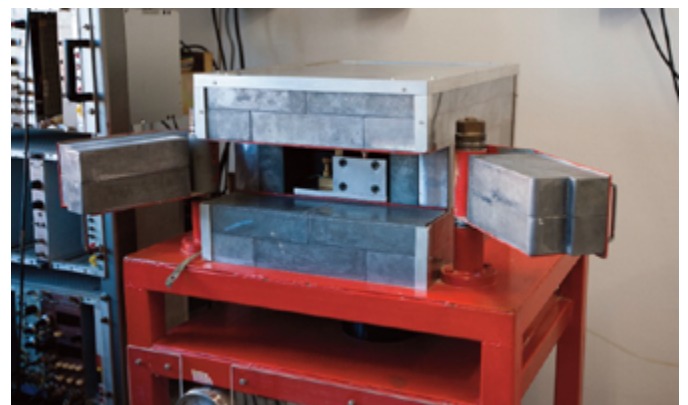
Campione nazionale di misure di attività di radionuclidi emettitori beta-gamma (sistema 4\pi\beta\text{-}\gamma )
