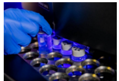
Scintillazione liquida per quantificare la presenza di beta emettitori
