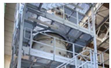
Prove di scambio termico e FIV su simulatori di generatori di vapore a tubi elicoidali (NuScale Power SMR)
