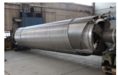
Prove di dry-out su un fascio di barre di un reattore BWR (10 MW; 70 bar)
