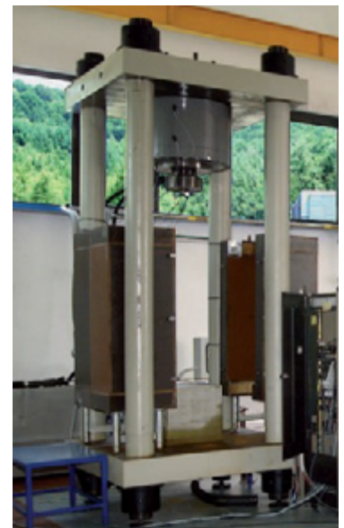
Macchina per fatica compressiva da 8000 kN
