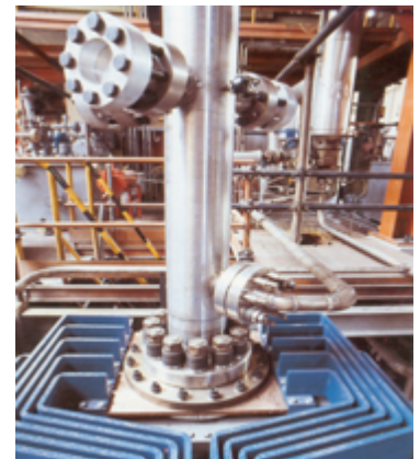
SPES-2 facility: upper head del canale di potenza (potenza: 5 MW, n. 97 barrette scaldanti)
