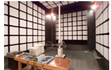
Vista interna della camera semianecoica "Vecuvia"
