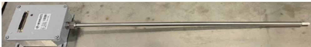
Sensore Ossigeno per impianto a piombo liquido
