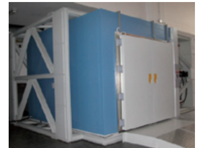
Camera climatica per prove di cicli termici.
