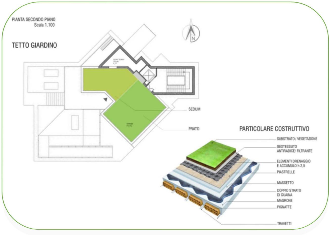
**Figura 5.17** - Dettagli del "tetto giardino" e della tipologia di substrato
