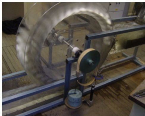
Modello in laboratorio di una ruota di fianco, alla Queen's University di Belfast
