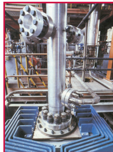
Impianto sperimentale SPES-2: testata superiore del canale di potenza (potenza: 5 MW, n. 97 barre riscaldate)
