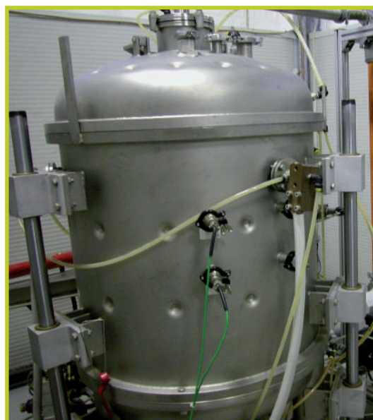
Impianto per CVI (Chemical Vapour Infiltration) per compositi a matrice ceramica
