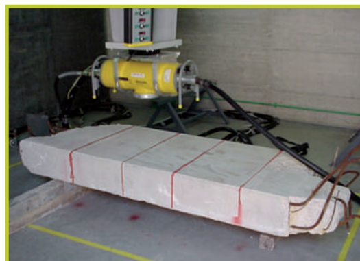
Apparecchio radiografico 20÷450 kV, 15 mA
