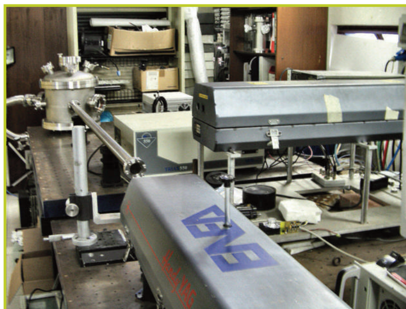
Sistema LIBS ad alta risoluzione, trasportabile, presente presso il Centro Ricerche ENEA di Frascati; sul fondo la camera di prova per esaminare remotamente i campioni sottovuoto (a distanza di 2 metri)
