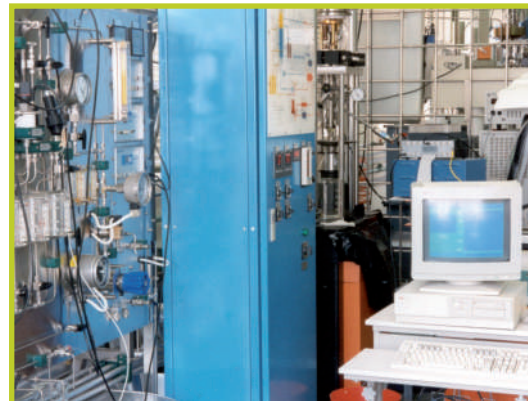
Circuito a ricircolo con autoclave per prove meccaniche in acqua ad alta temperatura e pressione: circuito bassa temperatura per il condizionamento e controllo della chimica dell'acqua
