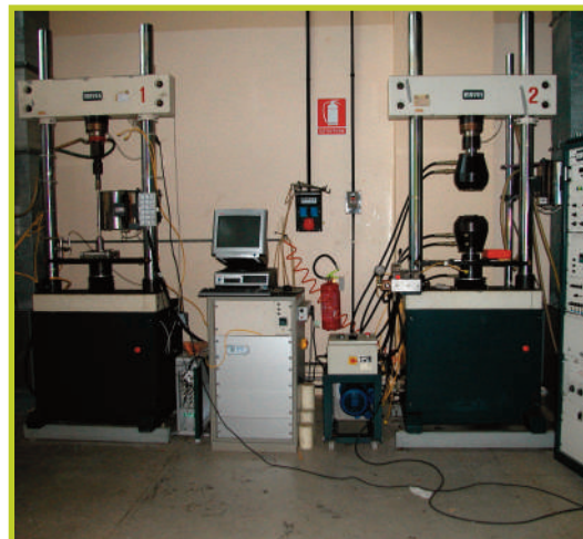
Macchine universali per prove meccaniche MAYES EMS 100 da 100 kN
