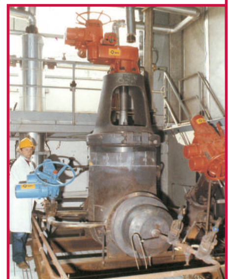
Prove di pressurizzazione su valvola di intercettazione
