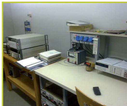
Sistema tradizionale per la taratura di accelerometri (frequenze 10 ÷ 10.000 Hz)
