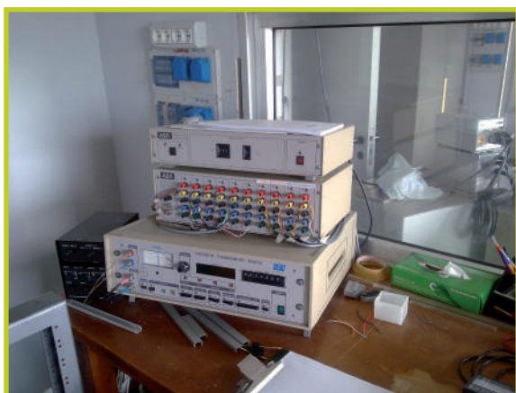
Sistema di taratura strumenti per la misura di temperature
