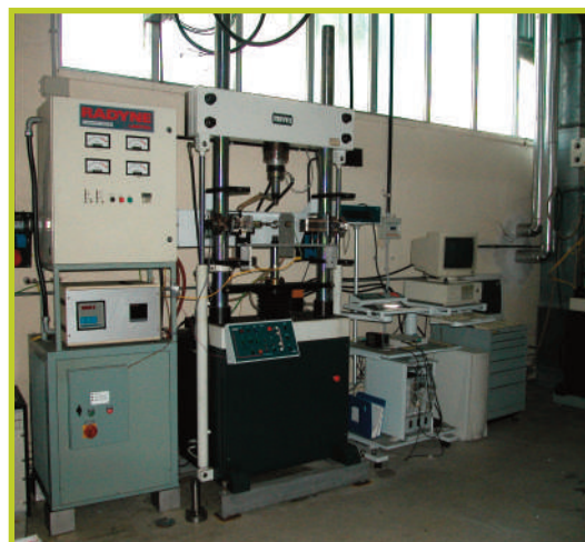
Macchina Universale Mayes da 100 kN per fatica termo-meccanica (riscaldamento induttivo)
