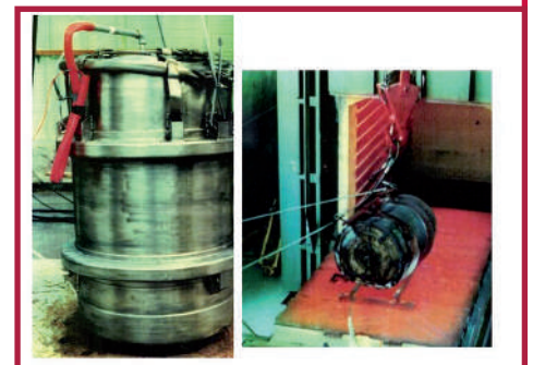
Contenitore di trasporto per soluzioni di plutonio dopo la prova di caduta da 9 m e invecchiamento termico a 800 °C per 30 minuti
