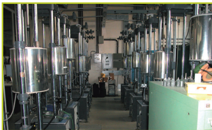
Vista di insieme delle macchine Mayes per prove di scorrimento viscoso (creep) strumentato
