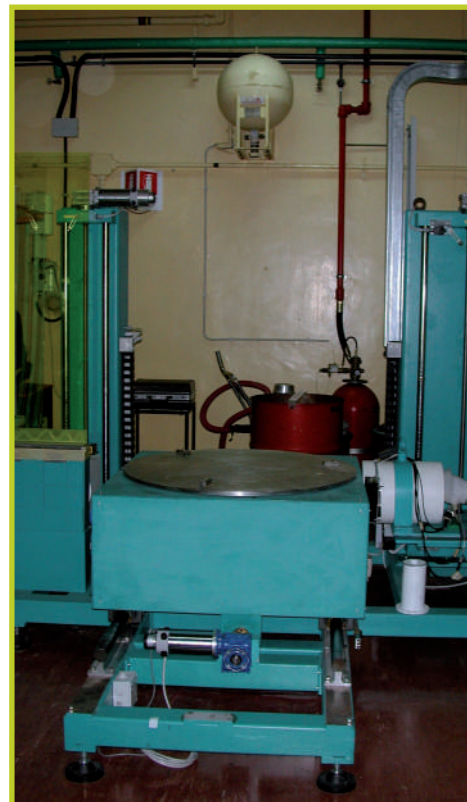
Misure su manufatti contenenti gamma-emettitori: Sistema di misura SRWGA (Sea Radioactive Waste Gamma Analyser)
