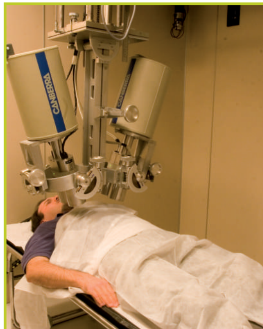
IRP Casaccia - Laboratorio misure in vivo (WBC): misura dell'attività nel polmone di radionuclidi con emissione X-gamma fra 10 keV e 100 keV
