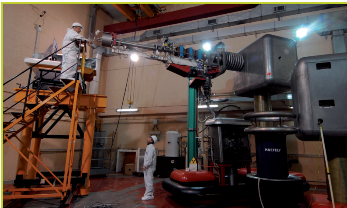
Preparazione di un irraggiamento di alcuni campioni da attivare con i neutroni prodotti da FNG
