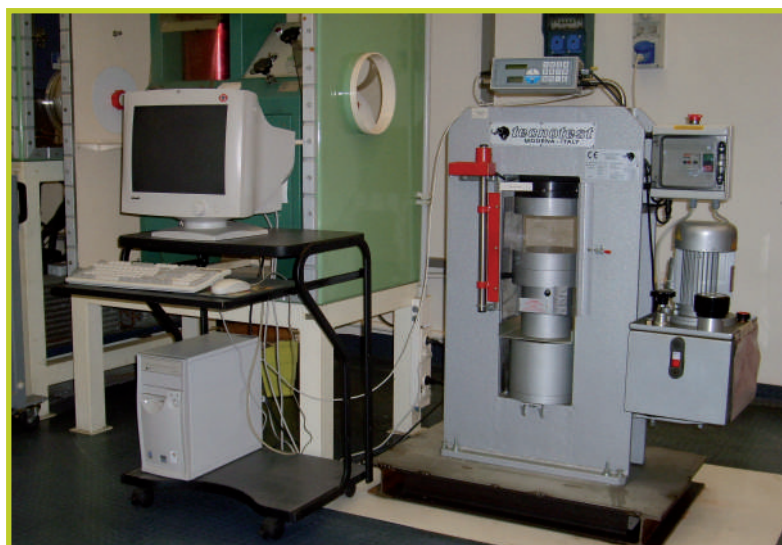
Resistenza a compressione: Pressa Tecnotest KC 150
