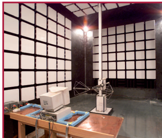
Vista interna della camera semianecoica "Vecuvia"
