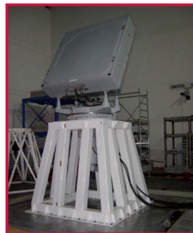
Test dinamico/funzionali su sistema d'antenna radar
