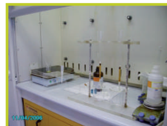
Trattamento radiochimico di campioni di bioassay per misure di isotopi del Plutonio e apparato di elettrodeposizione
