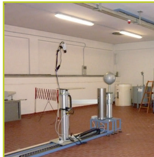
Centro taratura radiazioni ionizzanti (sala irraggiamento neutroni)
