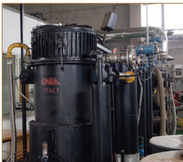
Gassificatore a letto fisso equicorrente (down-draft) da 30 e 80 kW e
