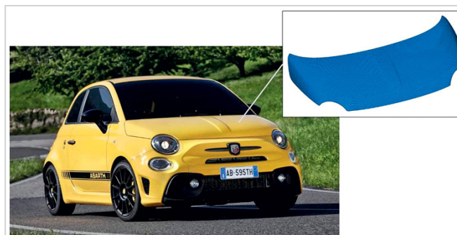
Cofano da produrre in composito totalmente in riciclabile, secondo la nuova tecnologia
