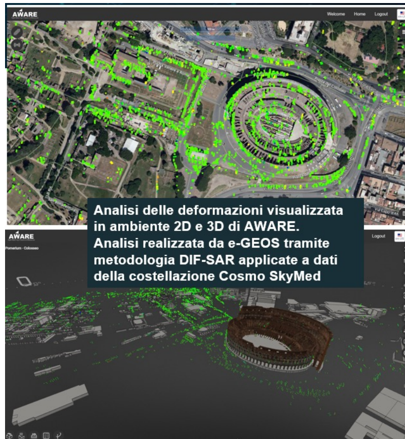
Figura 1 - Analisi dei movimenti del terreno e delle infrastrutture da dati storici sul Colosseo
