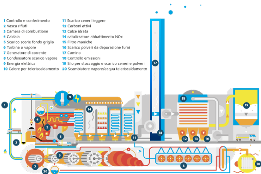
Figura 4 - Schematizzazione del processo di incenerimento dei rifiuti.
