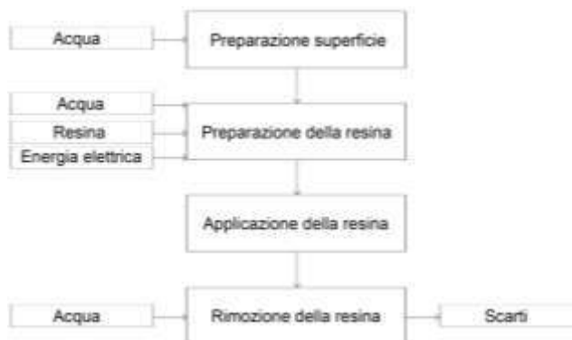
Figura 1: Flow chart relativa alla pulitura con resine a scambio ionico.
