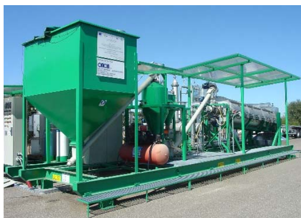
Figura 8 - Impianto pilota SICAV a tamburo rotante situato nel Centro di Ricerche ENEA-Trisaia
