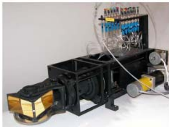
Figura 16 - Il sistema visivo e metrologico a radar ottico IVVIS
