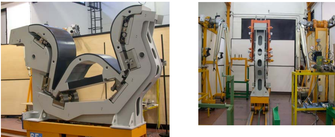
Figura 9 - Modello scala 1:1 del divertore di ITER e operazioni di RH presso il Centro del Brasimone
