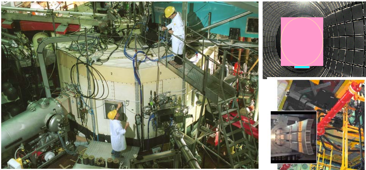
Figura 4 - FTU: La macchina; la camera del plasma e particolare del sistema di trasmissione della radiofrequenza
