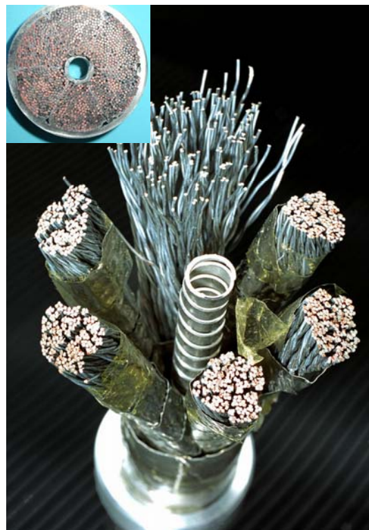
Figura 5 - Conduttore per le bobine prototipo di ITER
