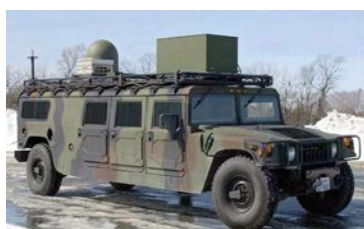
Prototipo CECOM - unità APU (PEFC 2 kW) installata sul tetto
