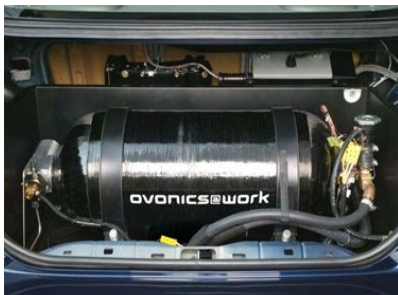
2006 - Serbatoio Ovonc (1500 psi, idruri metallici) Capacità: 3 kg H 2 Densità gravimetrica: 1,58 %p H 2 Volume: 50 L Peso: 190 kg
