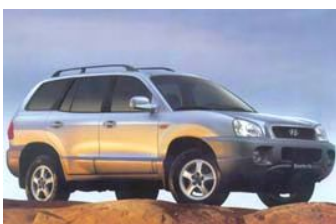
2000 - Hyundai Santa Fe FCEV Potenza: 75 kW (stack UTC Power) Autonomia: 160 km Velocità max: 124 km/h Combustibile: idrogeno (250 bar)
