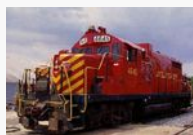
Locomotiva a celle a combustibile Potenza: 1,2 MW Idrogeno accumulato in idruri metallici (HERA) Coordinamento del progetto: Vehicle Projects LLC Altri partecipanti alla realizzazione del veicolo: AeroVironment, MesoFuel
