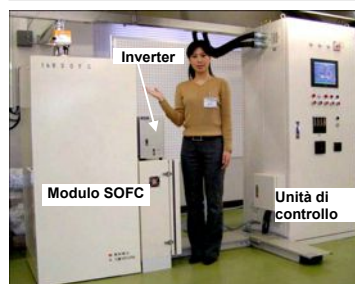
Unità CHP da 1 kW (3 a generazione, 2004)
