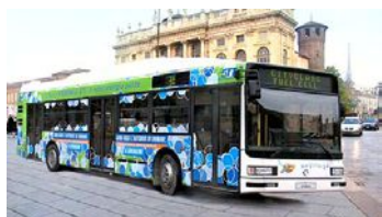
Progetto IRISBUS Motore: 150 kW (PEFC 60 kW) Alimentazione: idrogeno 200 bar (9 bombole x 140 L) Autonomia: 12 ore di esercizio Velocità max: 60 km/h
