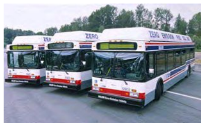
Flotta CTA (Chicago, USA) Programma dimostrativo 1998-2000: 5.000 ore di esercizio, 49.700 km percorsi, trasportati 100.000 passeggeri
