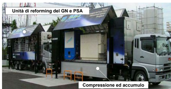
Stazione idrogeno Ome (Tokyo) - Progetto JHFC
