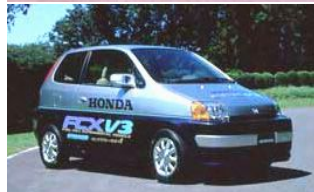
2000 - Honda FCX-V3 Potenza: 62 kW Autonomia: 180 km Velocità max: 130 km/h Combustibile: idrogeno (250 bar)
