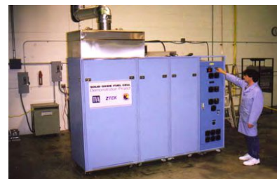
Sistema SOFC da 25 kW (Ztek)
