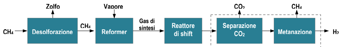
Diagramma di flusso semplificato di un impianto per la produzione di idrogeno per reforming del metano
