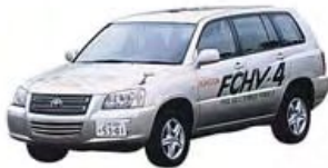
Giugno 2001-Toyota FCEV-4 Potenza: 90 kW (stack Toyota) / batteria Autonomia: 250 km Velocità max: 150km/h Combustibile: idrogeno (250 bar)
