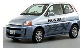
2003 - Honda FCX Potenza: 86 kW (2 stack Honda) Autonomia: 395 km Velocità max: 150 km/h Combustibile: idrogeno (350 bar)
