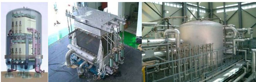
Stack KEPCO da 100 kW (2 stack da 50 kW, 90 celle ciascuno)
