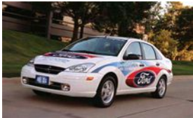
2002- Focus FCEV Hybrid Potenza: 68 kW (85 kW Ballard Mark900) batteria NiMH (Sanyo 216 V) Autonomia: 260-320 km Velocità max: 128 km/h Combustibile: idrogeno (350 bar)
