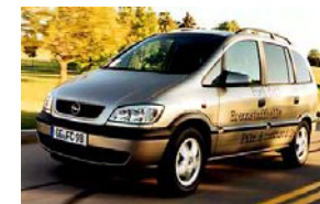
1998 - Opel Zafira Potenza celle: 50 kW (2 stack) Autonomia: 400-500 km Velocità max: 120 km/h Combustibile: metanolo
