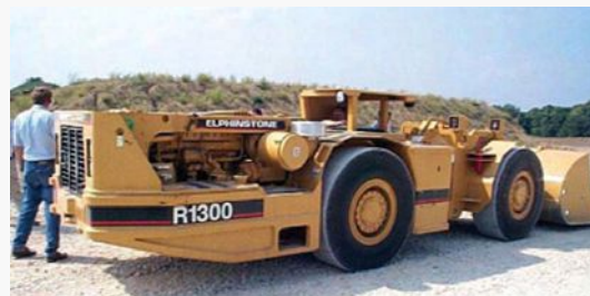
Veicolo per miniere Caterpillar-Elphinstone (2002-2006) Potenza: 160 kW (sistema ibrido PEFC 90 kW Nuvera / batteria NiMH Idrogeno accumulato in idruri metallici (HERA) Coordinamento del progetto: Vehicle Projects LLC Altri partecipanti alla realizzazione del veicolo: AeroVironment, Caterpillar, DRS-Technologies, Hydrogenics, Modine Manufacturing
