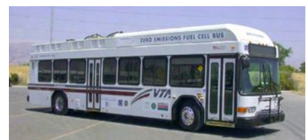
2004 - Autobus Gilling alla Santa Clara VTA Potenza: 205 kW (stack Ballard) Combustibile: idrogeno (350 bar, 55 kg)
