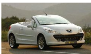
2006- 207 Epure Potenza: 20 kW (GENEPAC CEA) 50 kW batteria Li-ione Autonomia: 350 km Velocità max: 130 km/h Combust.: H 2 (5 bombole, 700 bar)
