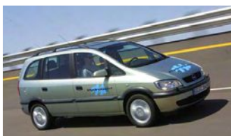
2000 - Hydrogen1 Potenza celle: 80 kW Autonomia: 400 km Velocità max: 140 km/h Combustibile: idrogeno liquido
