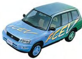
Settembre 1997-Toyota RAV4 FCEV Potenza: 25 kW (stack Toyota) / batteria Autonomia: 500 km Velocità max: 125 km/h Combustibile: metanolo
