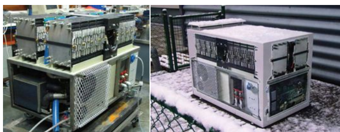
Sistema CHP 6 kW (4 stack AFC) - VITO / Intensys
