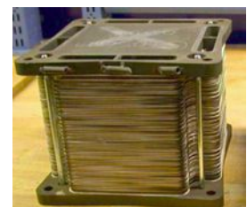
Stack SOFC VPS Potenza : 1,152 kW (28 celle, area attiva 121 cm 2 )
