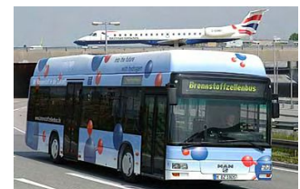
MAN - Fuel Cell Bus Potenza: 68 W stack Ballard Batteria NiMH 13 kWh Autonomia: 300 km Combustibile: idrogeno (350 bar)
