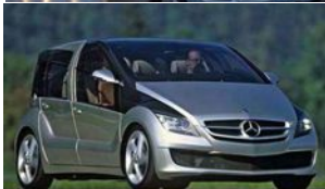
F600 HYGENIUS, 2005 Potenza: 66 kW Autonomia: > 400 km Velocità max.: 174 km/h Combustibile: idrogeno (700 bar) Batteria: Li-ione
