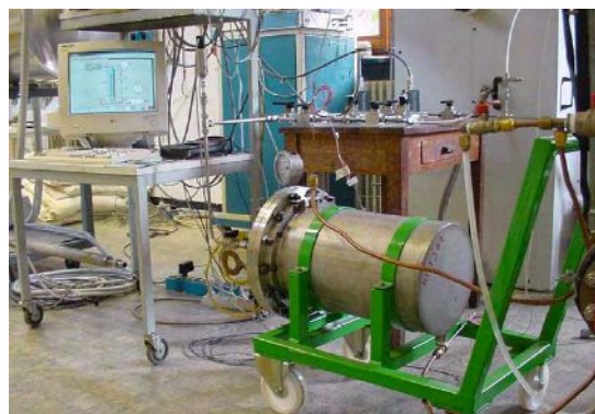
Il prototipo del sistema di accumulo in idruri metallici HS-6500 in prova presso i laboratori del CESI Ricerca
