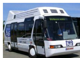
Neoplan - Autobus di Oberstdorf Potenza: 55 kW PEFC (Nuvera) 21 kW batteria Autonomia: 600 km Velocità max: 50 km/h
