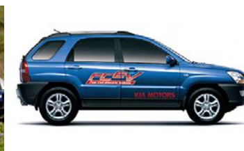
2004 - Kia Sportage Potenza: 80 kW (stack UTC Power) Autonomia: 300 km Velocità max: 150 km/h Combustibile: idrogeno (350 bar)
