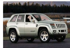
Potenza: celle 50 kW /batteria NiMH Autonomia: 190 km Combustibile: metanolo
