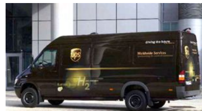
Sprinter van (vers. 2003) Potenza: celle 75 kW /batteria Autonomia: 150 km Velocità max: 120 km/h Combustibile: idrogeno (350 bar)
