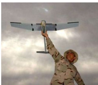
Esempio di veicolo UAV (Raven) Potenza: 80-200 W Peso batteria: 0,45 kg Densità di potenza: 177-444 W/kg
