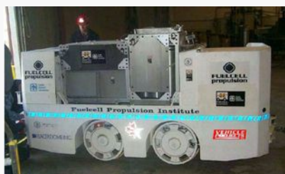
Locomotiva per miniere (2002) Unità PEFC Nuvera da 17 kW Idrogeno accumulato in Idruri metallici Coordinamento del progetto: Vehicle Projects LLC Partecipanti: CANMET, Hatch Associates, MSHA, Placer Dome, Sandia National Laboratories, Stuart Energy Systems (ora Hydrogenics), Nevada University / Reno.
