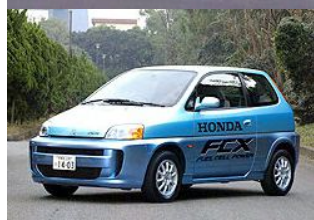
2002 - Honda FCX Potenza: 75 kW (stack Ballard Mark 900) Autonomia: 355 km Velocità max: 150 km/h Combustibile: idrogeno (350 bar)
