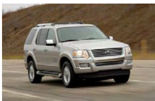
2006 - Ford Explorer Potenza: 60kW (stack Ballard) 50 kW Batteria NiMH Autonomia: 560 km Combustibile: idrogeno (700 bar)
