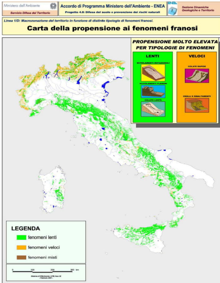
Figura 6.10 - Carta della franosità potenziale per diverse tipologie di eventi a scala nazionale
