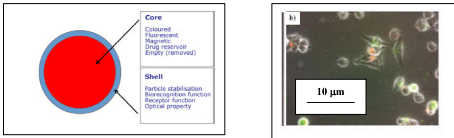
Fig. I.1.7 – A sx: nanoparticelle core-shell; a dx: visualizzazione di cellule con nanocristalli luminescenti 1
