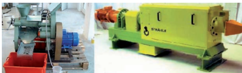
Figura 2.14 - Presse per l'estrazione di olio vegetale da 50 e da 300 kg/h
