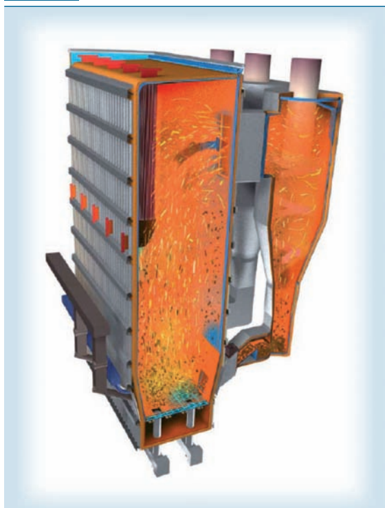
Fig. 3.24 Combustore a letto fluido ricircolante – CFB
