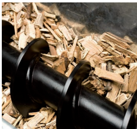
Figura 3.27 Coclea di trasporto del cippato
