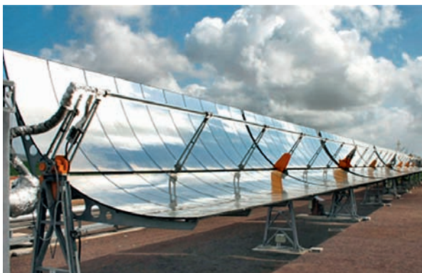
Figura 9.1 Collettore parabolico lineare. Specchi a sezione parabolica concentrano la radiazione solare su un tubo posto lungo la linea focale
