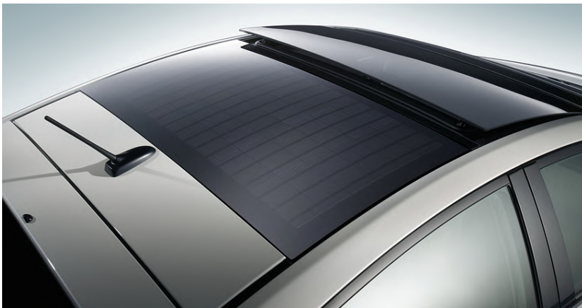
Fig. 17.2 - Particolare del tetto con pannelli solari della terza generazione della Prius
