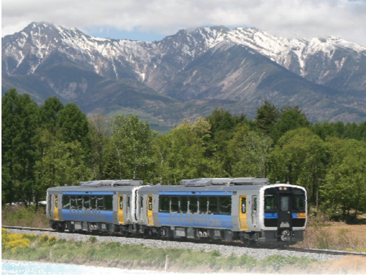
Fig. 22.7 - Convoglio ibrido diesel-elettrico KIHA-E200 in servizio in Giappone
