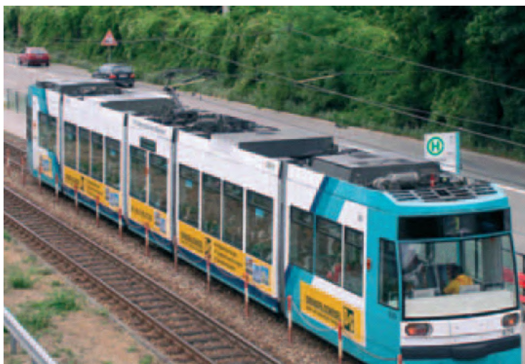
Fig. 22.6 - Tram ibrido con alimentazione aerea e sistema d'accumulo con supercondensatori realizzato dalla Bombardier, operante a Mannheim (Germania)
