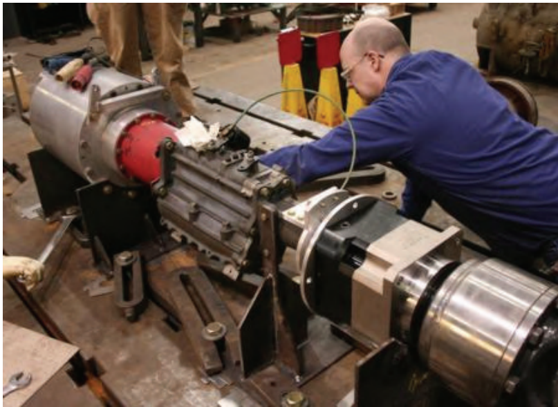
Fig. 25.5 - Il motore di trazione ed il complesso cambio/differenziale
