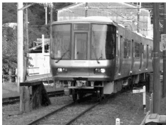
Fig. 22.8 - L'elettromotrice R291, con cella da 100 kW basata sullo stack Nuvera FC
