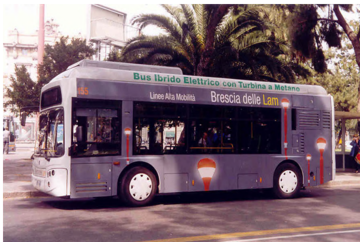
Fig. 19.10 - Il bus della EPT Horus, un ibrido da 8 metri con motore elettrico da 120 kW e gruppo di generazione con microturbina a gas naturale da 30 kW
