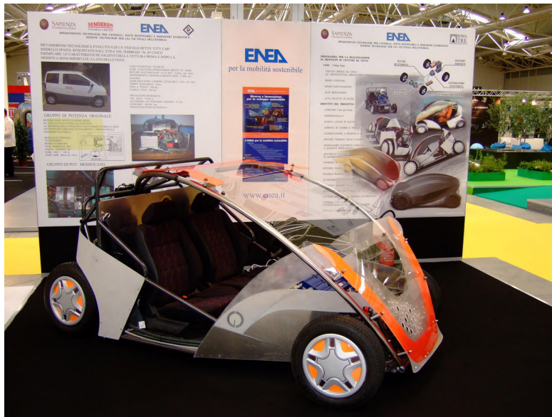
Fig. 16.2 - La Urb-e 1 , la micro vettura ibrido serie sviluppata in ENEA
