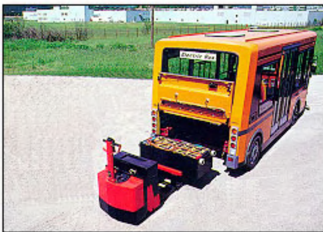
Fig. 19.4 - Sostituzione delle batterie in un veicolo Gulliver, realizzato da Tecnobus
