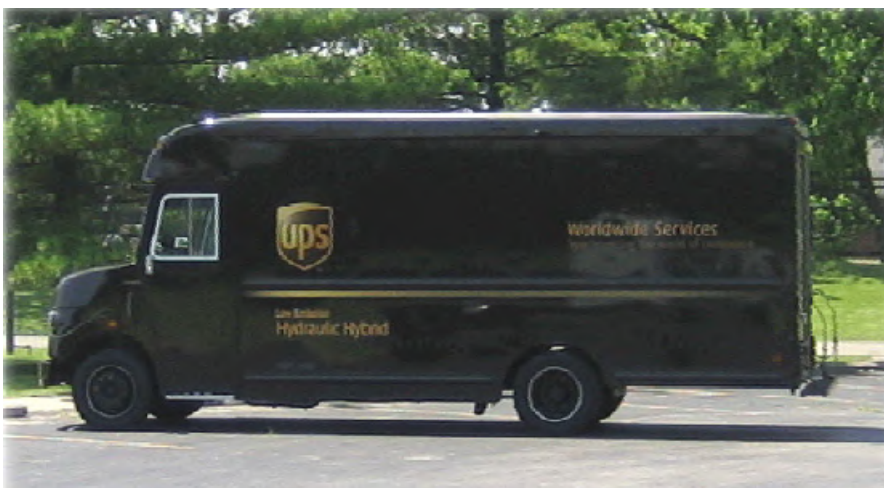
Fig. 8.17 - Veicolo ibrido sperimentale per la prova di un sistema di accumulo idraulico
