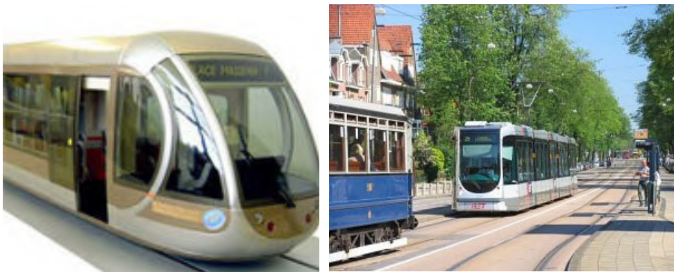
Fig. 22.5 - Tram ibridi realizzati da Alstom: (a sinistra) con accumulo elettrico a batterie nichel-idruri, operante a Nizza, Francia; (a destra) con accumulo a volani, operante a Rotterdam, Olanda
