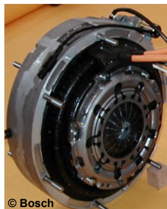
Fig. 6.14 - Esempi di macchine sincrone a MP e ad induzione per applicazioni ibride parallele single shaft
