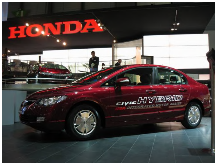
Fig. 17.4 - La Honda Civic Hybrid, con motore a benzina da 1.300 ed elettrico da 15 kW
