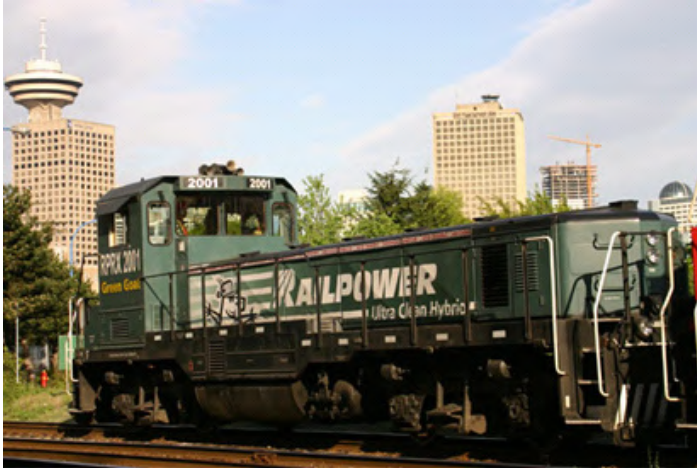
Fig. 22.9 - Il locomotore diesel-elettrico Green Goat, realizzato dalla nord-americana RailPower
