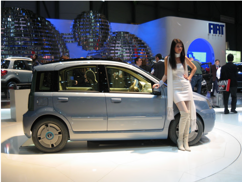
Fig. 17.12 - La Panda Hydrogen, dotata di motore elettrico di trazione alimentato solamente da celle a combustibile, quindi senza batterie. L'idrogeno che alimenta le celle è contenuto, alla pressione di 350 bar, in un serbatoio di materiale composito, installato sotto il pianale posteriore della vettura
