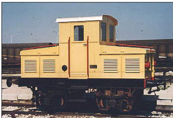
Fig. 22.3 - Locomotore da manovra ad accumulatori conservato al Museo Ferroviario di Trieste
