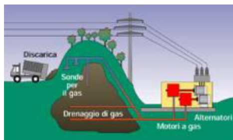
Figura 2.74 - Schematizzazione del processo di produzione del biogas in discarica (Credit: www.poweron.ch )
