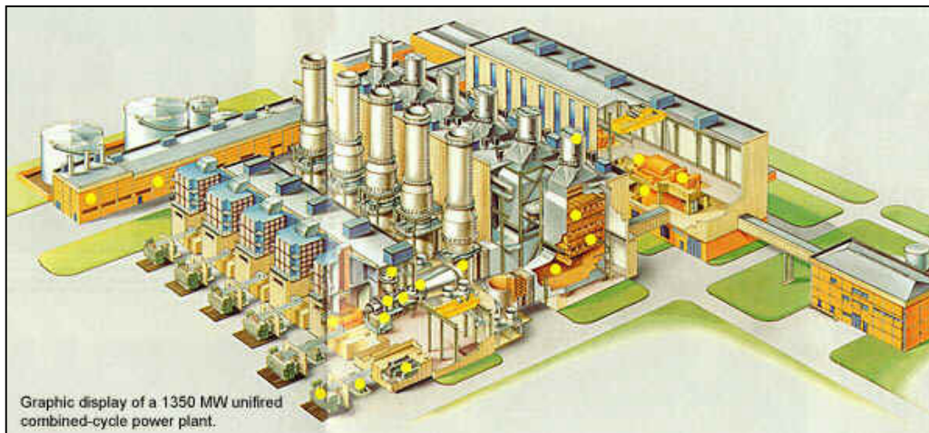
Figura 3.17 - Vista d'insieme di una centrale a ciclo combinato raffreddata con torri a secco
