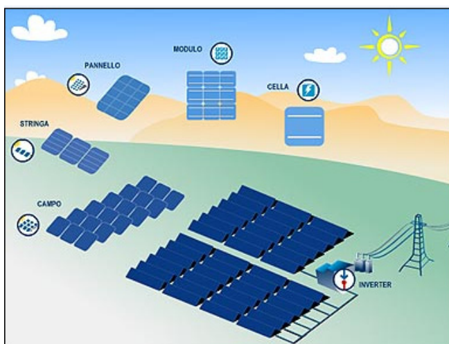
Figura 2.15 - Rappresentazione schematica delle parti costituenti un campo fotovoltaico e una cella fotovoltaica
