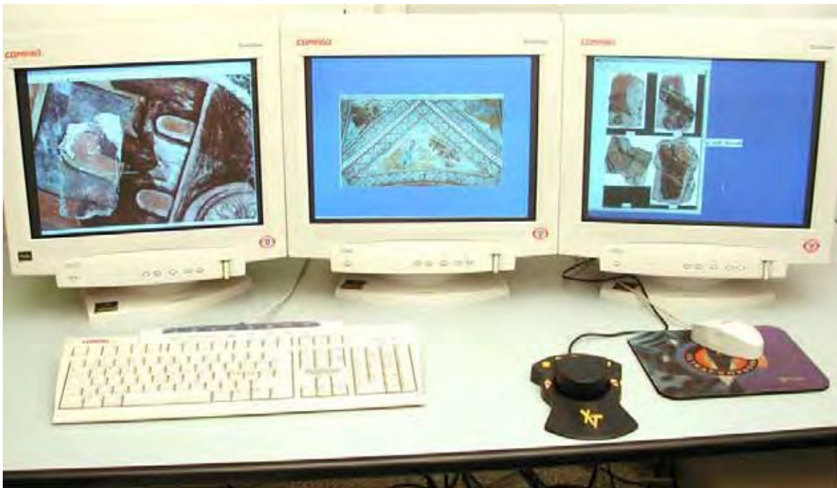
Figura 1 - La stazione client utilizzata dai restauratori. Sul monitor di sinistra è visibile lo spazio di lavoro sul quale (se disponibile) viene visualizzata a risoluzione massima la parte dell'immagine di riferimento dell'affresco su cui si sta lavorando. Questo schermo costituisce la controparte virtuale del tavolo sul quale in cantiere viene collocata la foto a dimensioni reali dell'affresco per ricercare la collocazione dei frammenti. Sul monitor centrale un'altra finestra mostra l'immagine dell'affresco, scalata per poter essere visibile completamente, che viene utilizzata per cambiare l'area di lavoro. Altre finestre (monitor a destra) vengono dedicate ad ospitare contenitori virtuali, equivalenti ai cassetti utilizzati in cantiere per organizzare i frammenti in gruppi logicamente omogenei
