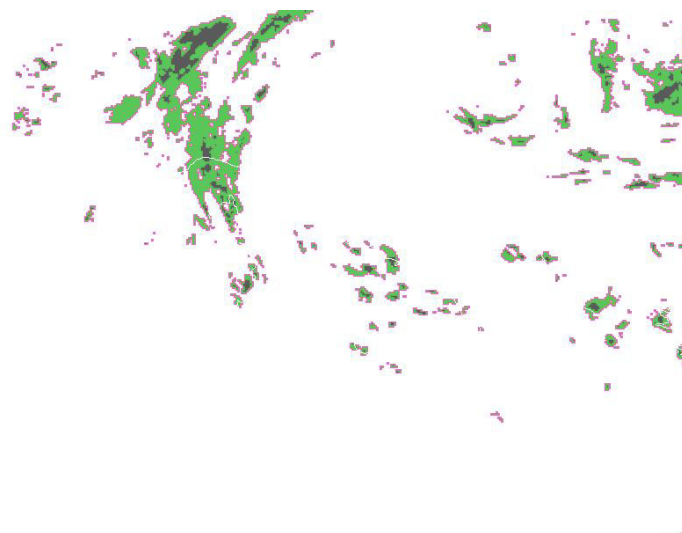
Figura 158 - Immagine stima di precipitazione fornita dalla tecnica NAW ricavata dai dati IR del Meteosat 7 nel canale IR (19/02/2005). Soglie di pioggia in ordine di colore decrescente: nero=8 mm/h, verde=2 mm/h, bianco=0 mm/h
