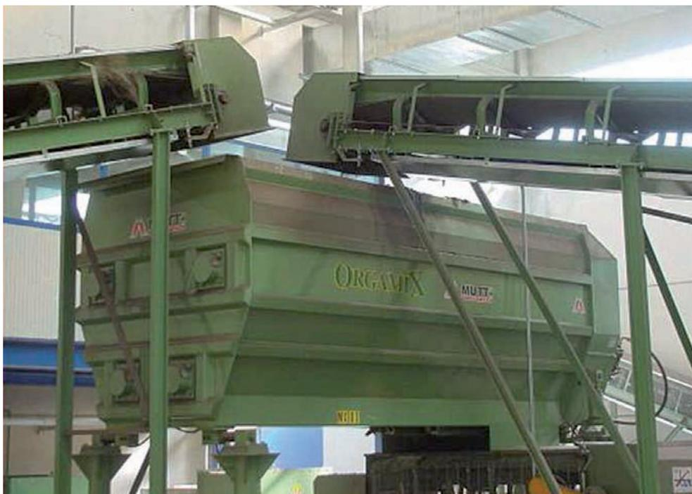
colta differenziata, scarti mercatali) o mediante pala meccanica se l'organico è molto umido come nel caso dei fanghi. Il controllo dell'apporto delle due componenti può essere ottenuto mediante celle di carico.
