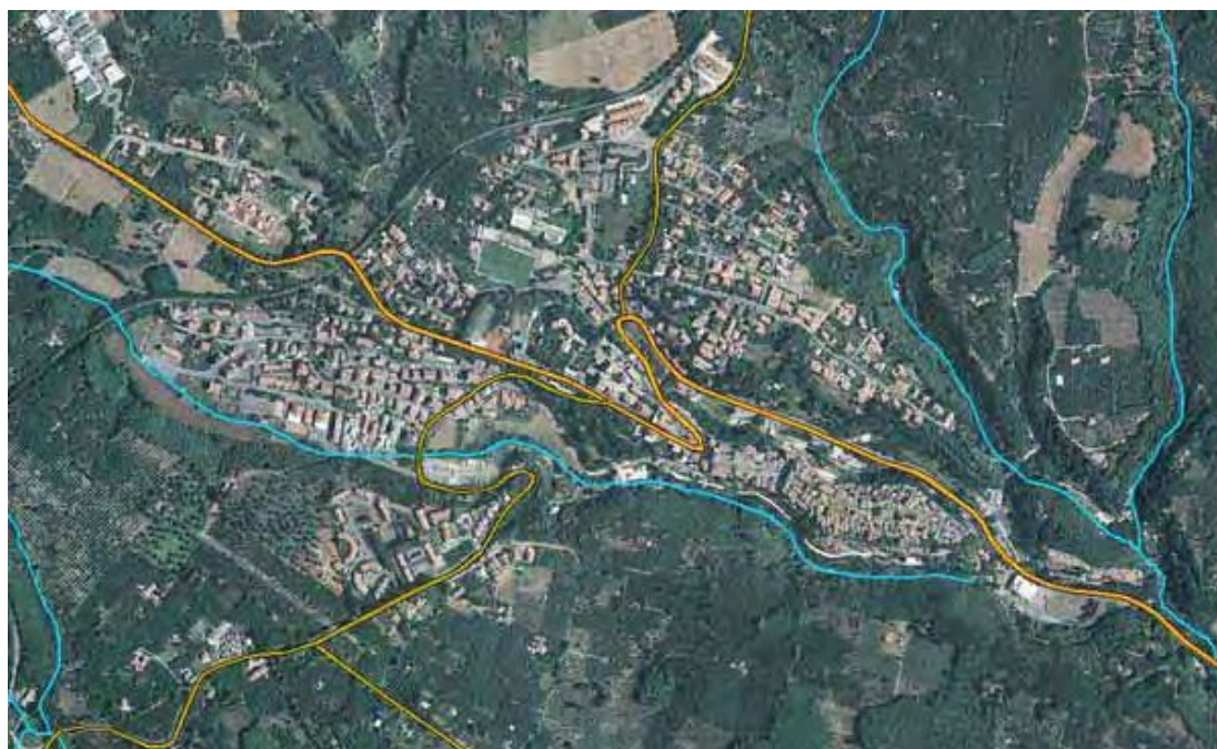
Figura 3.8 - Esempio di sovrapposizione di dati raster (ortofoto) con dati vettoriali (strade principali, fiumi)
