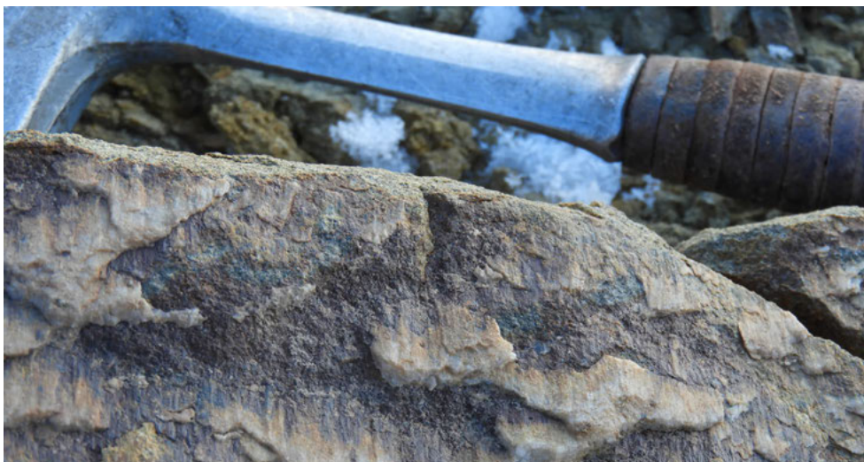
Prog. 2016/B2.02: Slickenfibers a carbonati in zona di faglia nelle Arenarie del Beacon Supergroup
