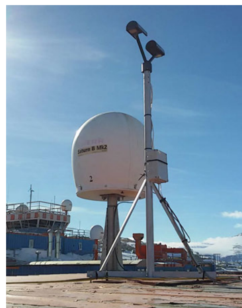
Prog. 2015/AZ3.02: Disdrometro OTT Parsivel per la misura della precipitazione di APP a MZS
