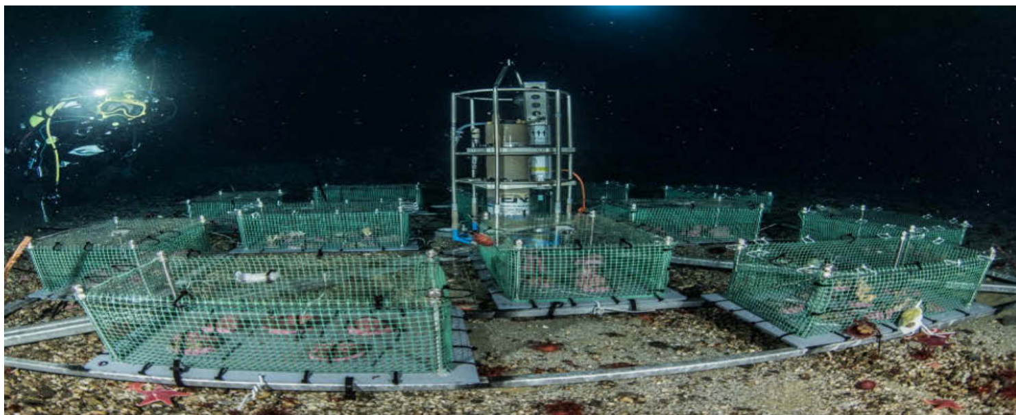
Prog. 2016/AZ1.09: Campo sperimentale, con gabbie a briozoi ed alghe e sonda multiparametrica presso il sito de 'La Zecca' a 25.5 m di profondità
