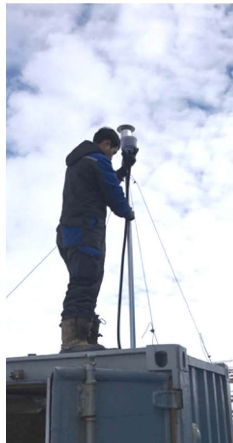
Prog. 2016/B3.01: Installazione della testa di prelievo
