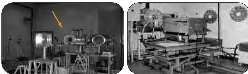
Figure 7 e 8 I sistemi campione "camera ad aria libera" (al centro della foto a destra) e "camera a cavità" (indicata dalla freccia nella foto a sinistra) realizzati presso l'Istituto Nazionale di Metrologia delle Radiazioni Ionizzanti dell'ENEA per la misura assoluta dell'esposizione dovuta, rispettivamente, a radiazione x con energia da 50 a 300 keV e a radiazione gamma da 1,25 MeV
