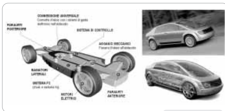
Figura 6 Il telaio di Autonomy ed il prototipo Hy-wire
