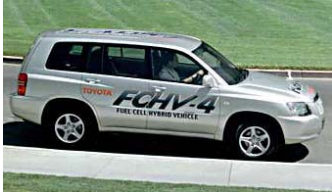
Toyota FCHV-4 (giugno 2001) Potenza: 90 kW Combustibile: idrogeno Autonomia: > 250 km Velocità max: 150 km/h
