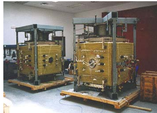
Moduli per impianto MCFC da 100 kW (laboratori Ansaldo Ricerche)
