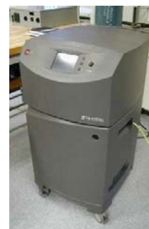
Unità da 1 kW a idrogeno
