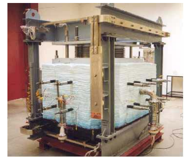
Stack MCFC "STAD-3" (AFCo)
