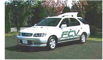
Nissan FCV Potenza cella: 10 kW
