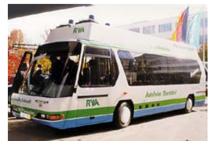
Neoplan - Autobus in esercizio a Oberstdorf Potenza: 55 kW Autonomia: 600 km Velocità max: 30-50 km/h
