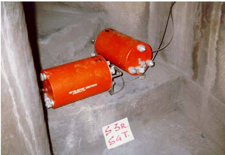
Foto 3.1 - Sensori S3R e S4T lungo la scala
