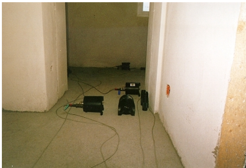
Foto 6.1 - Prove sul giunto sismico
