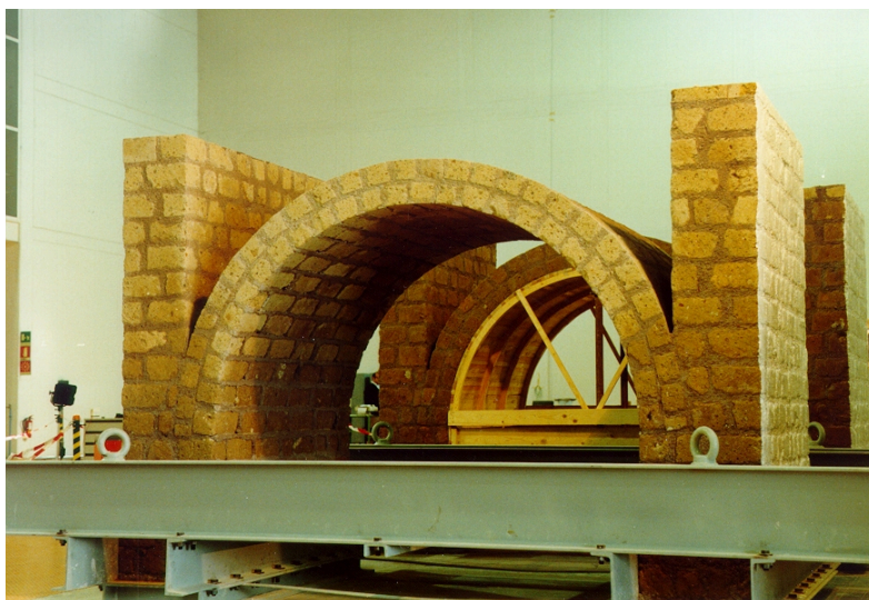
Foto 10.1 - I due archi soggetti a prova
