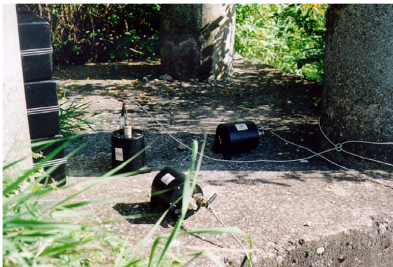
Foto 11.4 - Terna sismometrica al piede di una pila
