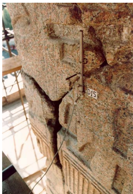
Foto 2.4 - Trasduttore di spostamento relativo su lesione
