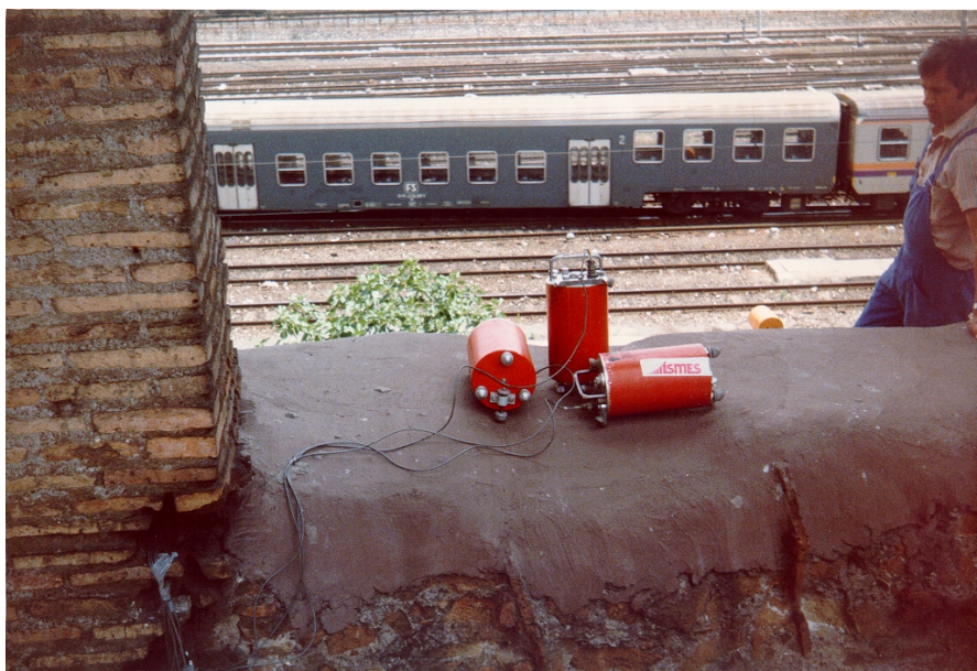
Foto 5.1 - Rilievo delle vibrazioni indotte dal traffico ferroviario
