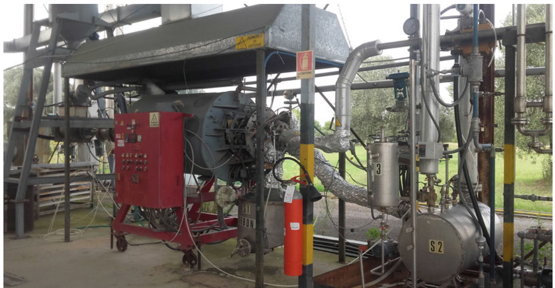
Figura 35: Impianto di pirolisi – gassificazione a tamburo rotante
