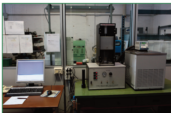
Termoflussimetro 2022 della ANTER Corporation per misure di conducibilità termica nel range -30÷300 °C
