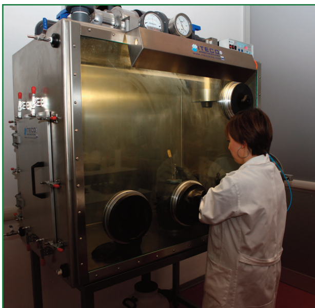
Glove box per manipolazione precursori
