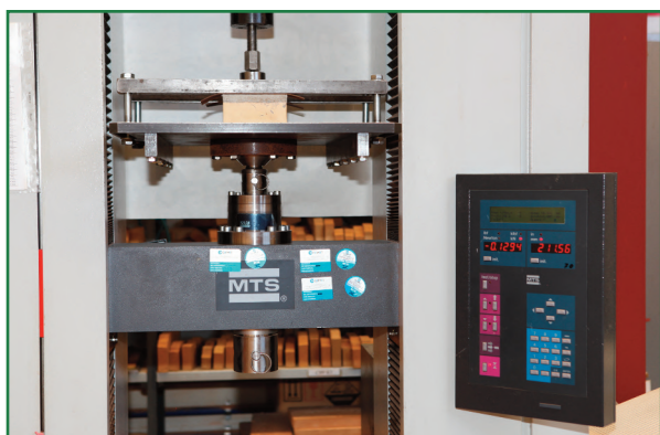
Macchina monoassiale a vite per prove meccaniche statiche con cella di carico da 20 e 150 kN. Costruttore: MTS
