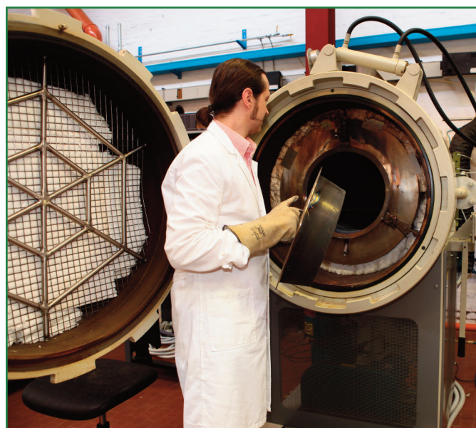
Forno per processo PIP (Polymer Impregnation Pyrolysis)
