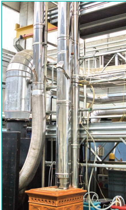
Tunnel di diluizione per la misura delle emissioni di particolato condensabile
