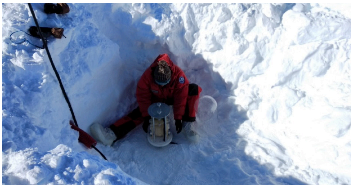
Prog. OSS-02: Operazione di posizionamento e orientazione del magnetometro vettoriale/scalare a Concordia
