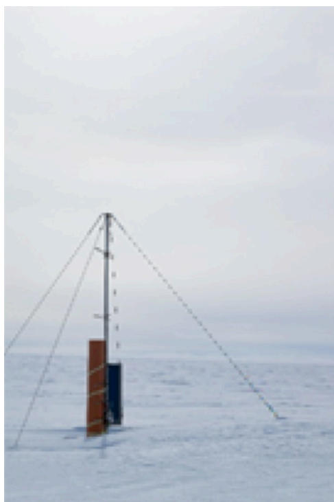
Prog. 2015/AZ3.01: Deposimetro installato presso la stazione meteo automatica sul Larsen Glacier
