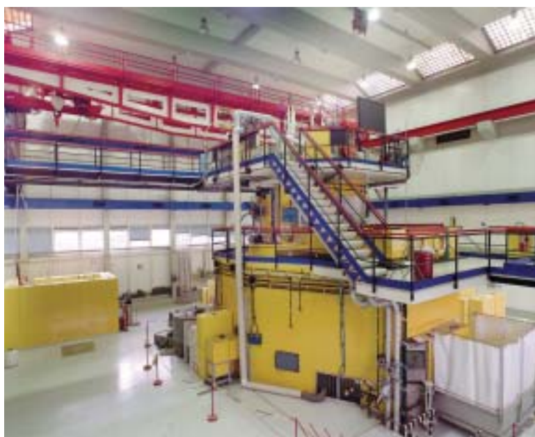
TRIGA RC-1, reattore nucleare di ricerca della potenza di 1 MW per applicazioni che riguardano la diagnostica e la terapia medica, la diagnostica industriale e la conservazione dei beni culturali
