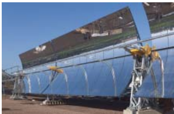
Impianto per Prove su Collettori Solari realizzato nell'ambito del programma di sviluppo di sistemi solari a concentrazione per la produzione di calore ad alta temperatura
