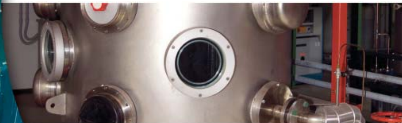
Impianto THESIS per prove di termoidraulica di blanket raffreddati ad acqua per il progetto ITER
