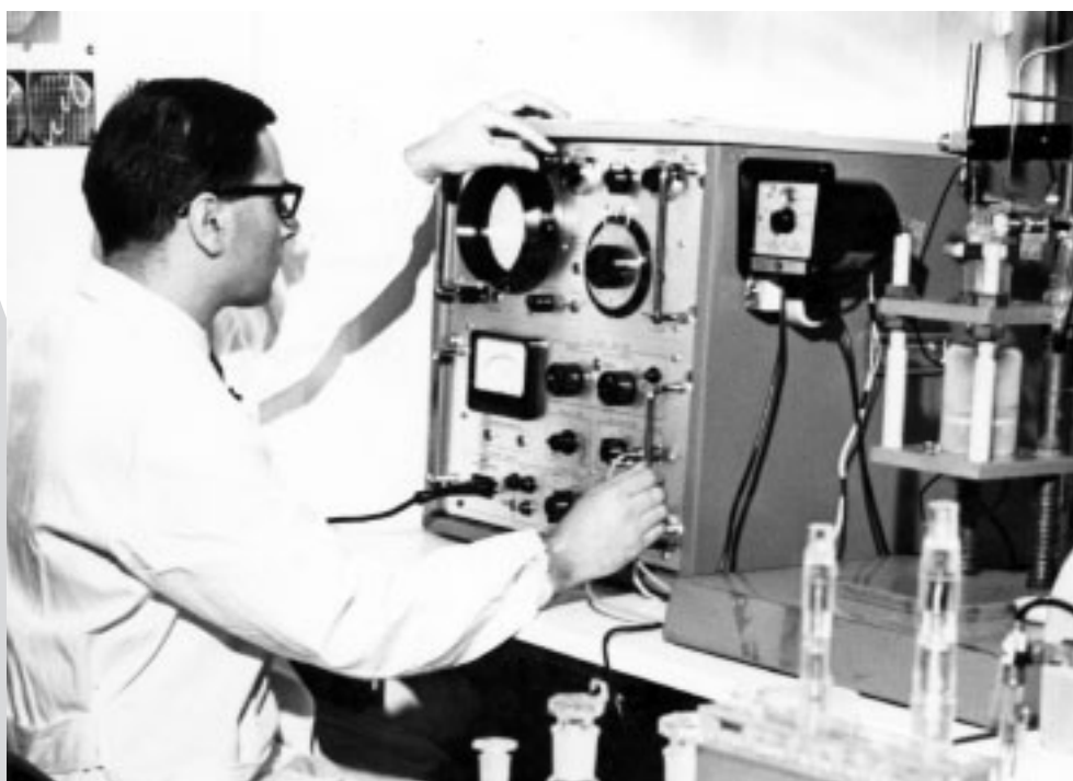
Polarografo per la determina- zione dei metalli in acqua di mare (foto anni 70)
