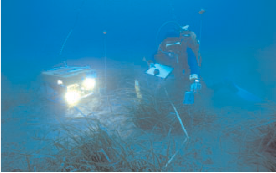
Rilevamento integrato tramite telecamera subacquea filoguidata (ROV) e censimenti visivi con operatore scientifico subacqueo per la mappatura delle praterie di Posidonia
