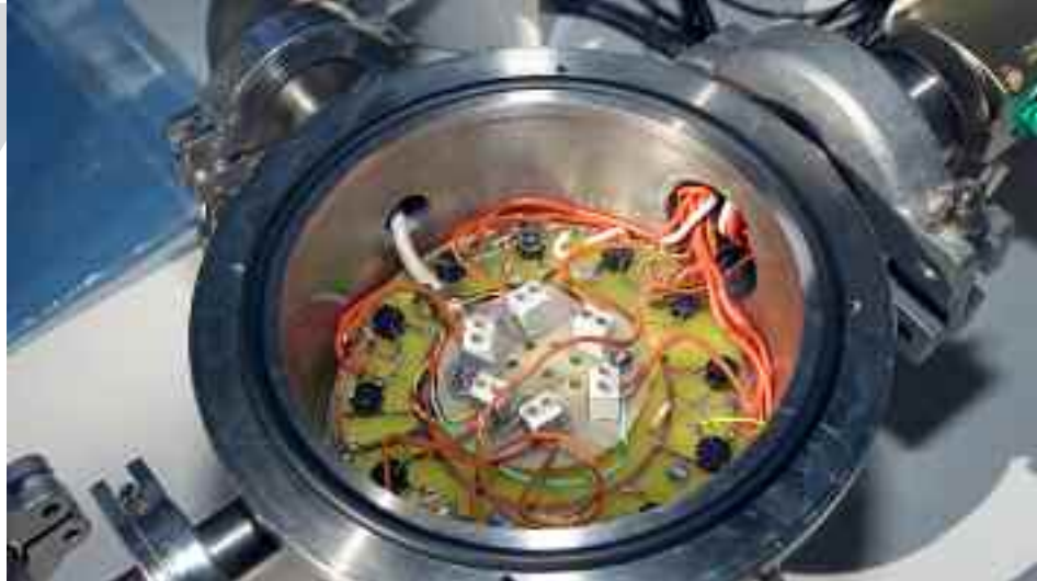
Camera di prova per sensori resistivi e sensori ad onda acustica superficiale
