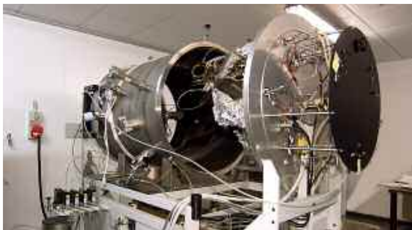
Laboratorio deposizione film sottili. Sistema di deposizione mediante bombardamento con fascio ionico
