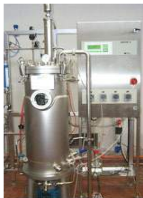
Bioraffineria: pretrattamento di biomasse tramite Steam Explosion e fermentatori
