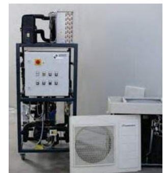
Calorimetro per la caratterizzazione di pompe di calore prototipali e commerciali, in collaborazione con l'industria italiana
