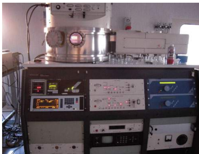
Impianto di sputtering a radiofrequenza per la realizzazione di componenti ottici
