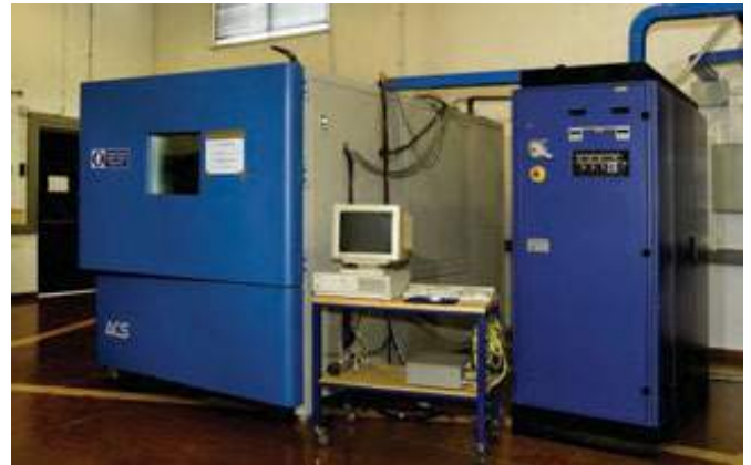
Ciclatore e camera climatica per prove di caratterizzazione e vita di batterie
