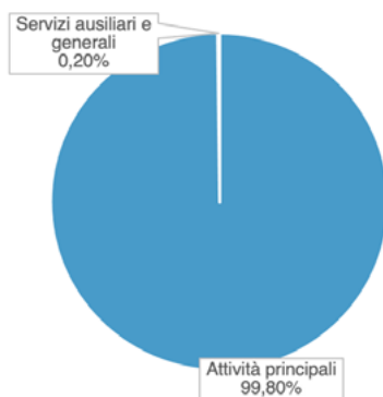
Figura 10 – Ripartizione dei consumi termici per la produzione di cemento grigio tra le differenti aree funzionali
